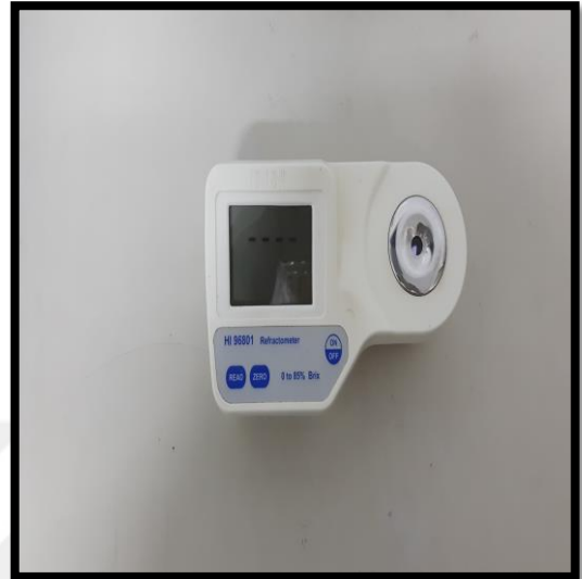
Resim 3.27. Suda çözünebilir kuru madde miktarının ölçümünün yapıldığı refraktometre ve ölçümün yapılmasından genel bir görünüm
