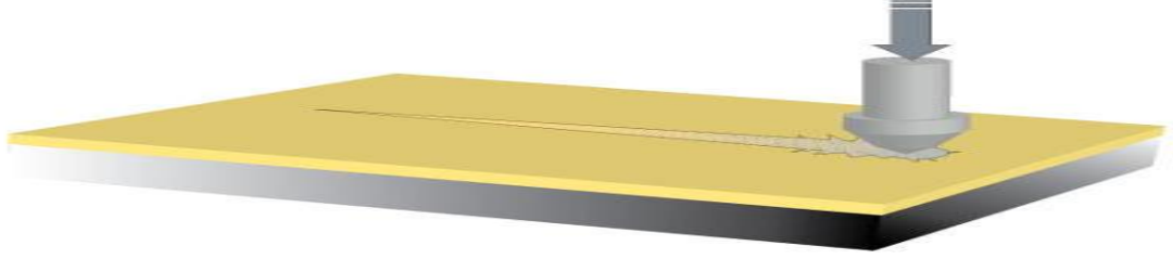
Şekil 2.2. Mikro çizik test cihazının nasıl ölçüm yaptığını gösteren çizim.
