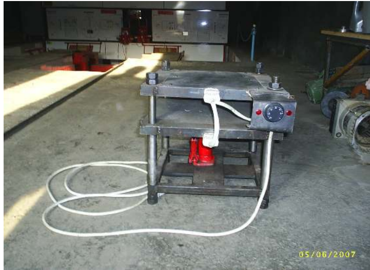
Şekil 7. Kompozit Malzemeleri Üretmek İçin Kullanılan Sıcak Pres.
