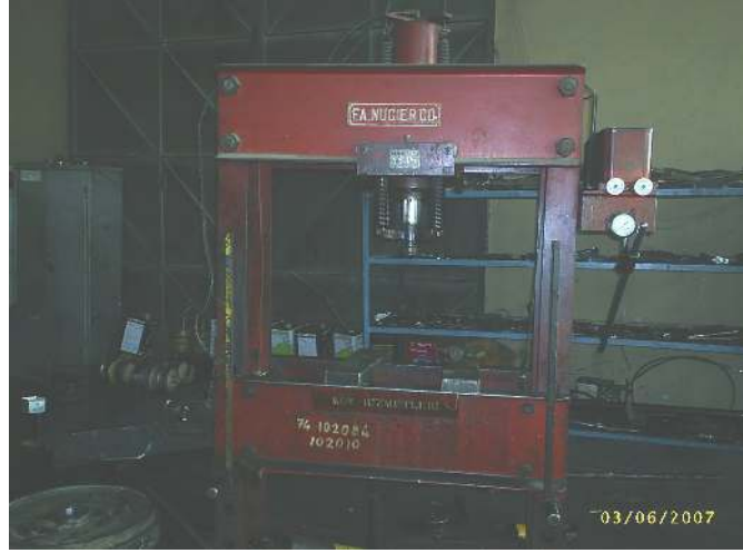
Şekil 6. Kompozit Malzemeleri Üretmek İçin Kullanılan Soğuk Pres.
