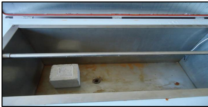
Şekil 4.8 Donma-çözülme deneyinde kullanılan cihaz
