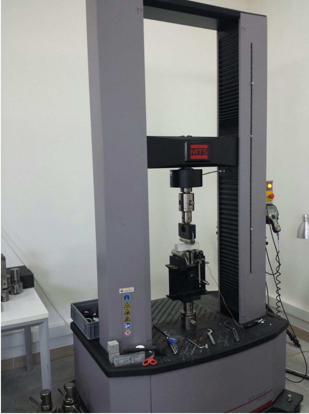
Şekil 4.11 Eğilme dayanımı deneyi için kullanılan pres
