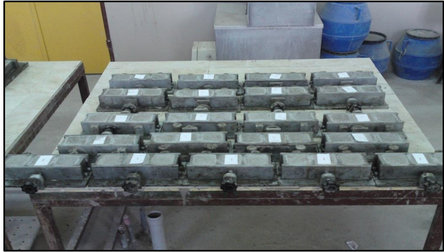
Şekil 4.6 Dayanım deneyleri için üretilen 50 mm küp numuneler
