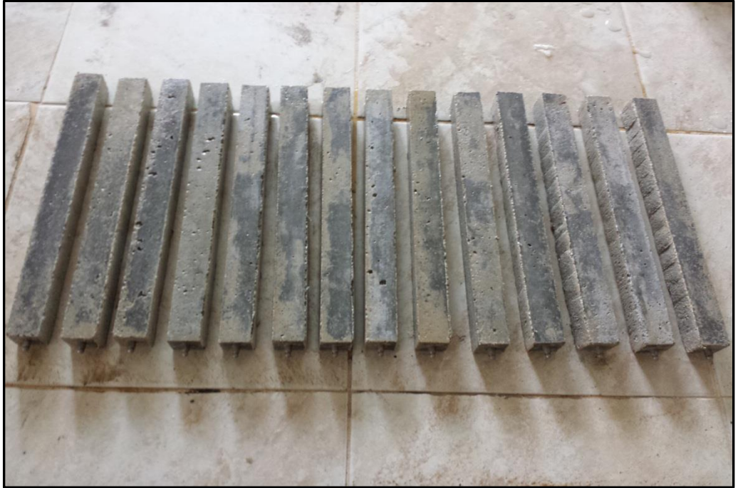
Şekil 4.9 Büzülme deneyine tabi tutulan 25×25×285 mm’lik çubuklar
