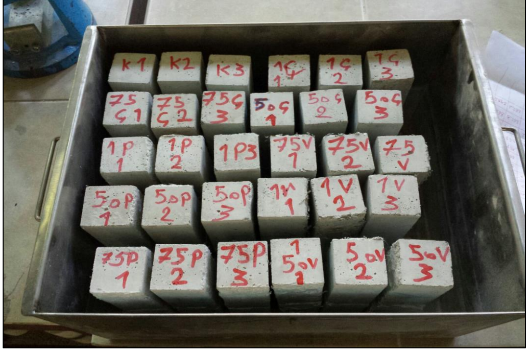
Şekil 4.5 Kapiler su emme numuneleri ve kullanılan tepsi
