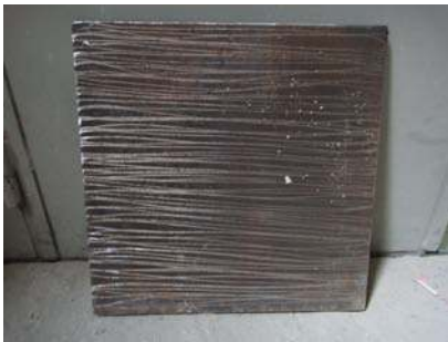
Resim 3.4. Kare deney elemanın pürüzlü yüzeyi
