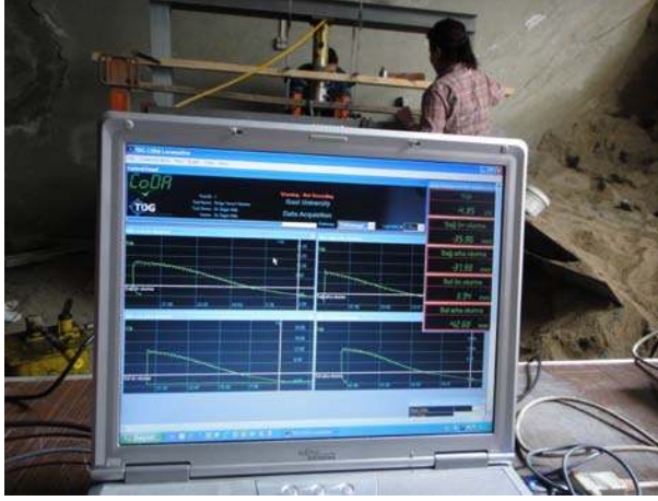
Resim 3.2. LVDT ölçümlerini kaydeden bilgisayar
