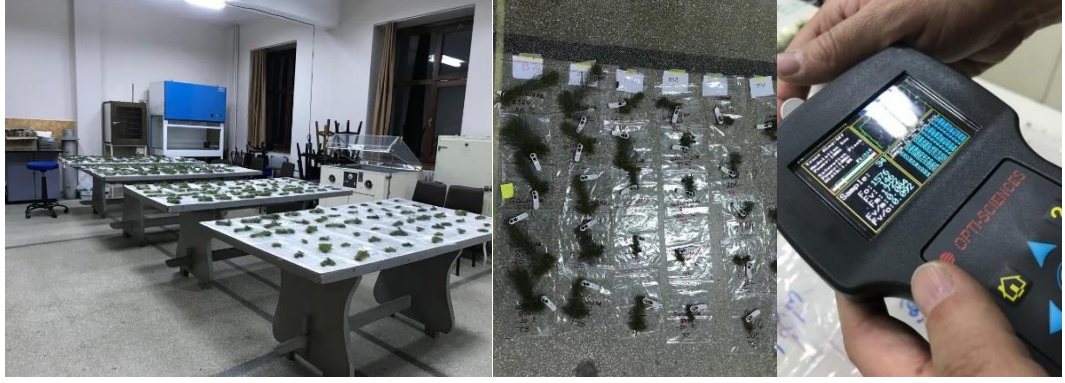
Şekil 14. CF yöntemi ile don zararının belirlenmesi
