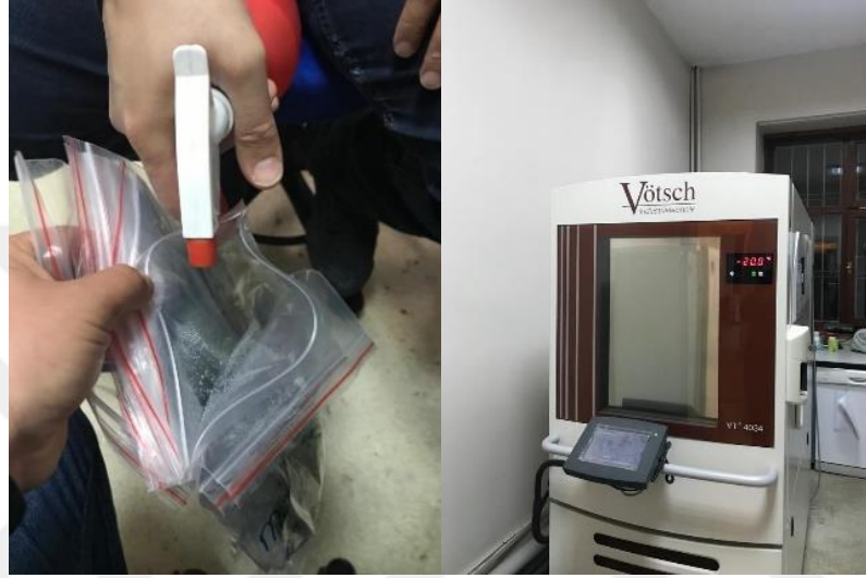
Şekil 13. Örneklerin ısıtılarak soğutucu kabine konması
