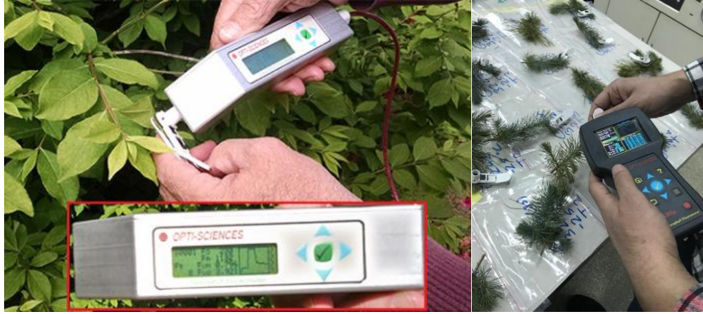
Şekil 7. Klorofil florometre ile klorofil floresans ölçümleri
