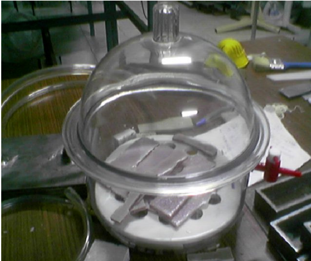
Resim 3.6. Koruyucu kap ( fırlama sonrası numunelerin bekletildiği )
