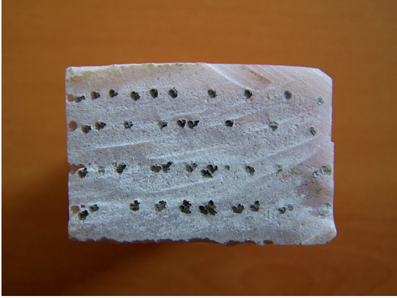
Resim 4.7. Eğme deneyi numunesi fiberlerin dizilişi [1,9]
