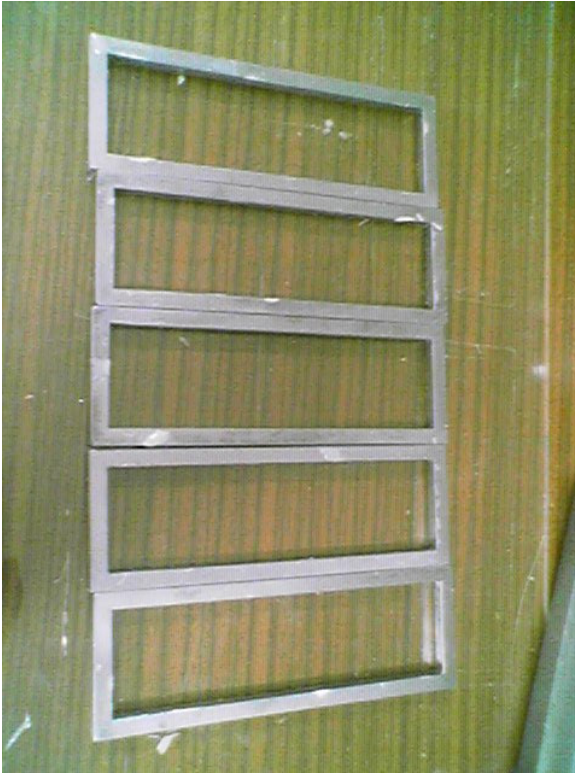
Resim 3.3. Çift taraflı açma deney numuneleri için döküm kalıpları
