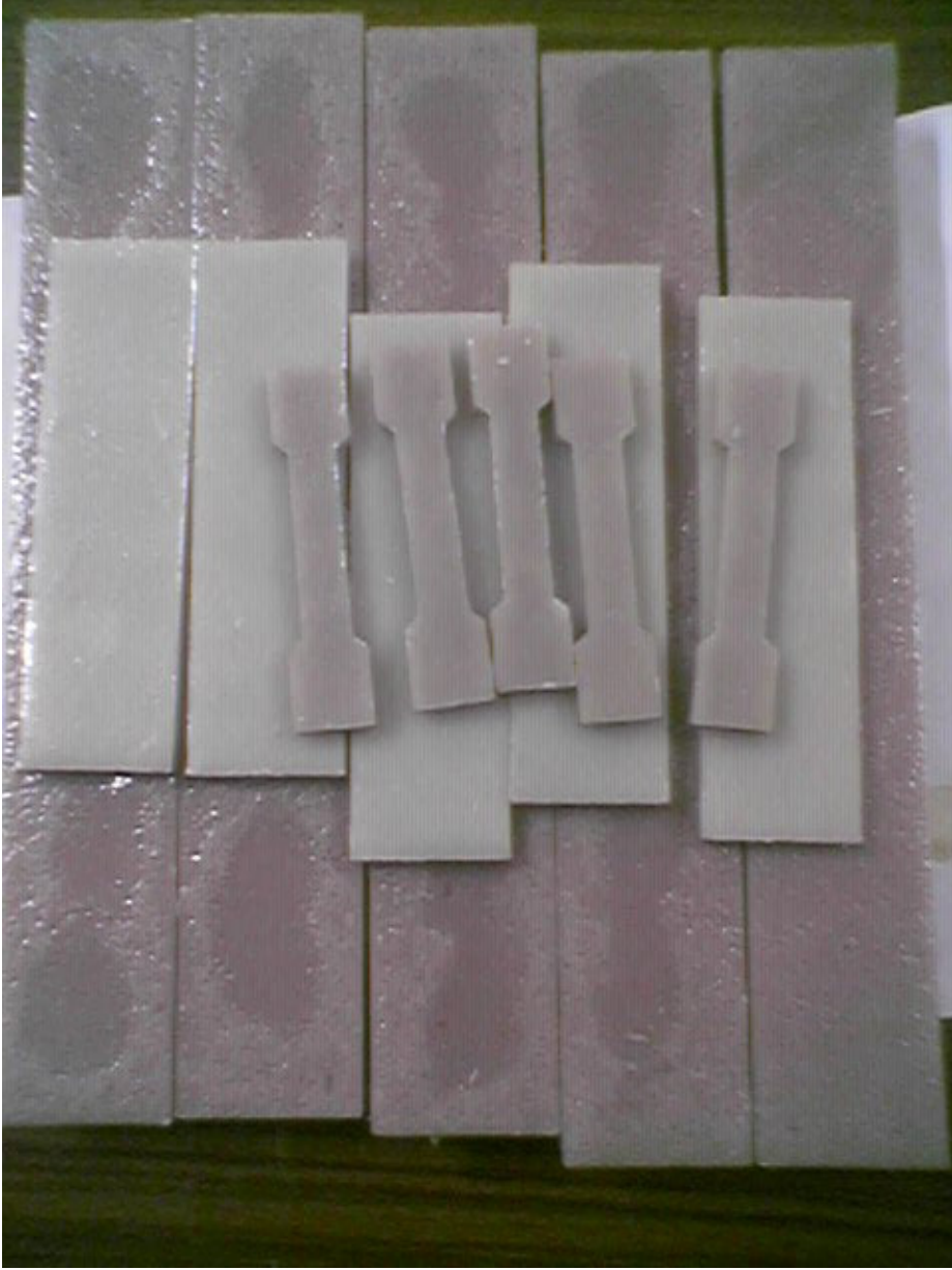
Resim 3.5. Kalıplardan çıkarılan numuneler ( eğme, çekme, açma numuneleri )
