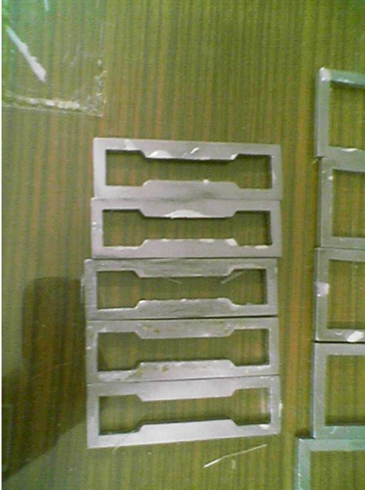
Resim 3.1. Çekme deneyi numuneleri için döküm kalıpları
