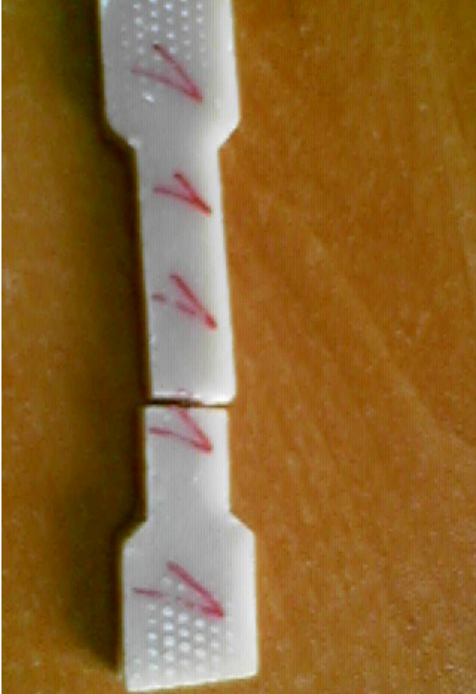
Resim 4.6. Kırılan çekme numunesi
