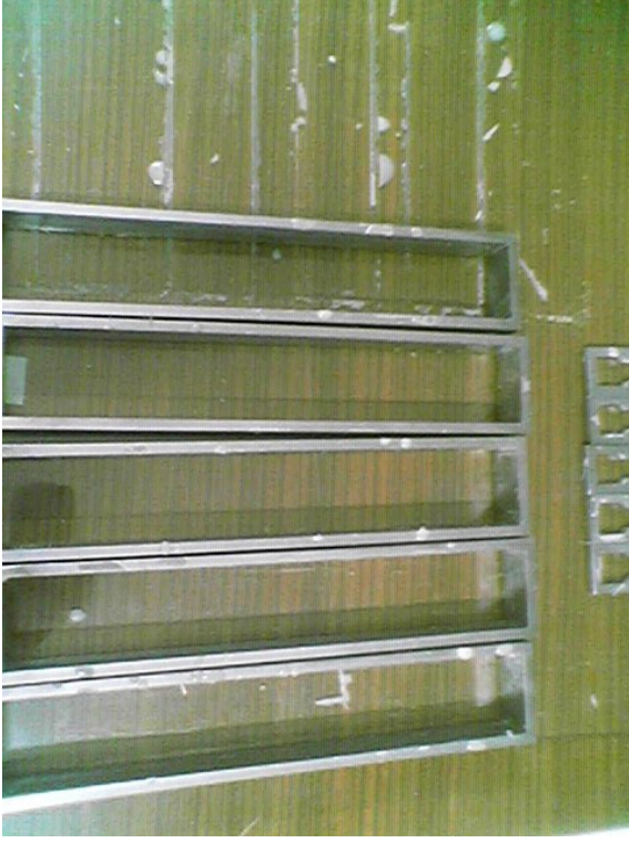
Resim 3.2. Eğme deney numuneleri için döküm kalıpları
