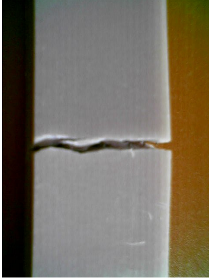
Resim 4.9. Eğme I fiber takviyeli numune kırılma kesiti
