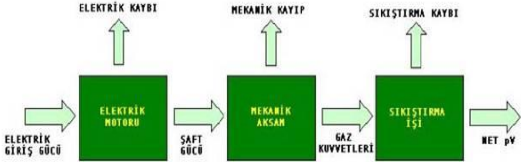
Şekil 2.7 : Kompresörde elektriksel giriş gücünün dağılımı. [6]
