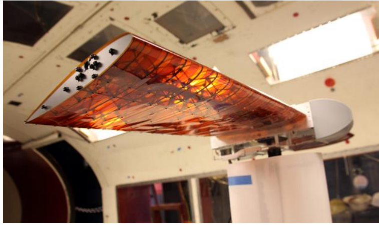
Şekil 2.20. NASA 'da tasarlanan elastik kanat profili
