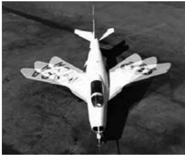
Şekil 2.6. Bell X-5 uçağının geçiş fazları
