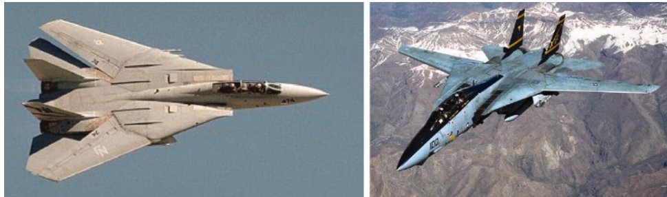
Şekil 2.8. F14 uçağının 20^\circ ile 68^\circ arasında değişimi
