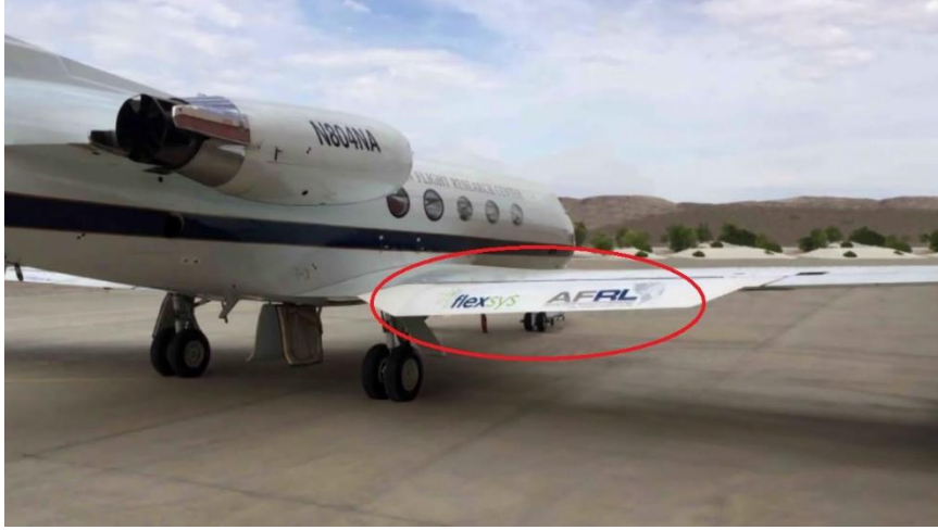
Şekil 2.17. FlexSys Inc. Firmasının tasarladığı esnek kanat flapı
