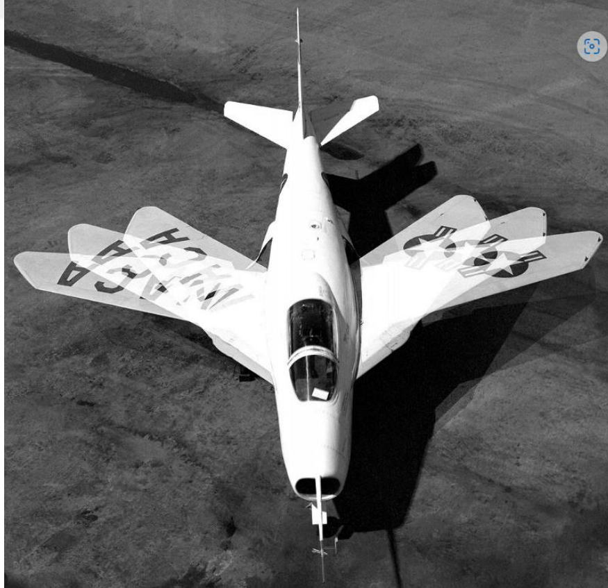
Şekil 2.1. Bell X-5 uçağının değişen ok açılı kanat gösterimi
