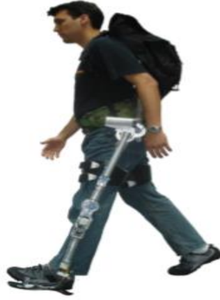
Şekil 1.8. MIT tarafından geliştirilen dış iskelet
