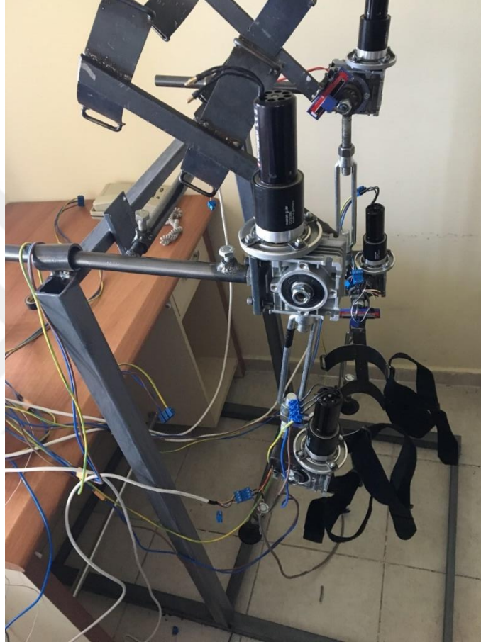
Şekil 1.2. Yük taşımaya yardımcı alt ekstremité dış iskelet sisteminin genel görünümü
