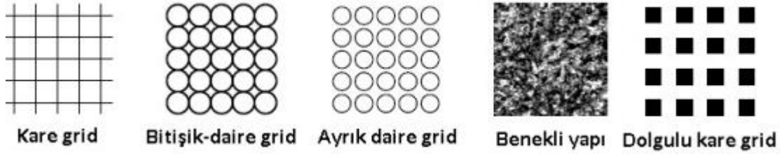
Şekil 2.5. Grid analizi için yaygın olarak kullanılan grid şablonları (ASAME Reference Manual)
