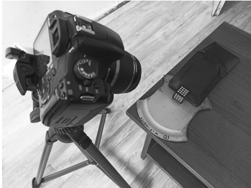
Şekil 2.6. Malzeme üzerindeki gridleri okuma sistemi
