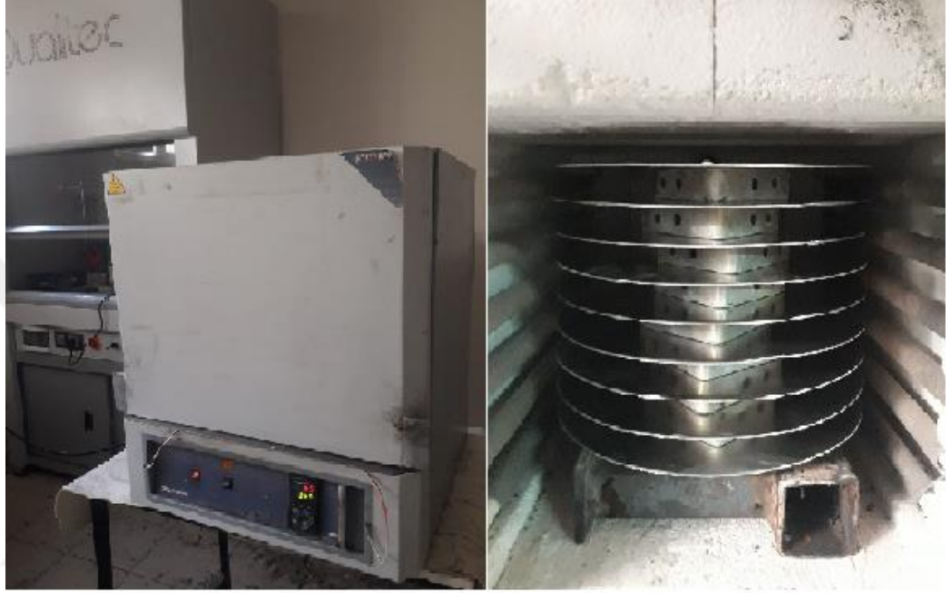
Şekil 15. Nakajima test numunelerinin kül fırınında ısıtılması
