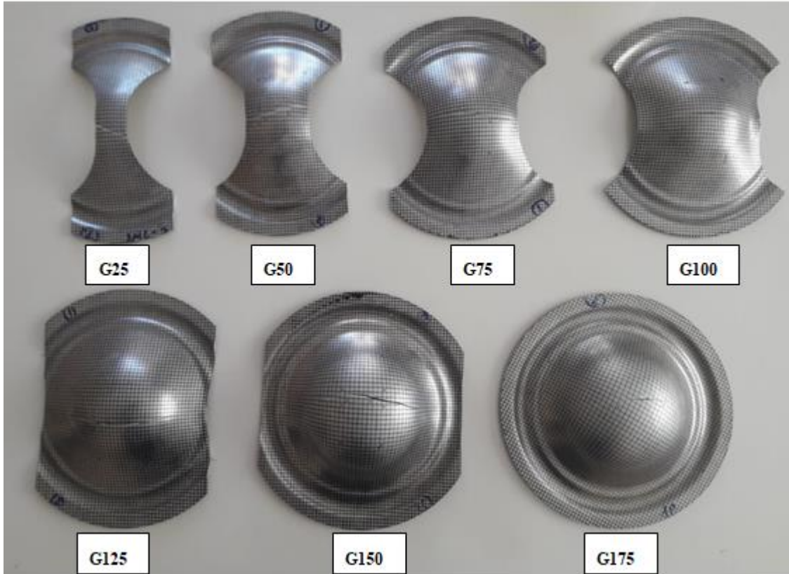
Şekil 4.2. Şekillendirilmiş yedi çeşit Nakajima test numunesi
