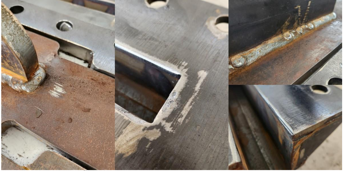
Şekil 4.42 BÖÇ-11 numunesinin sürtünmeye bağlı deformasyon izleri
