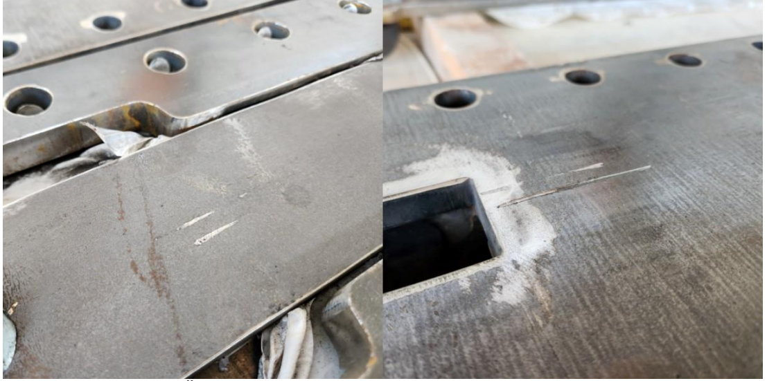
Şekil 4.18 BÖÇ-05 numunesinin sürtünmeye bağlı deformasyon izleri
