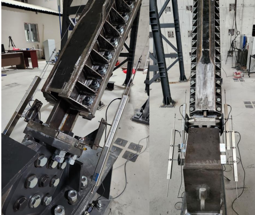
Şekil 3.15 Sırasıyla eksenel deformasyonu ve kayma miktarını ölçmek için kullanılan LVDT'ler
