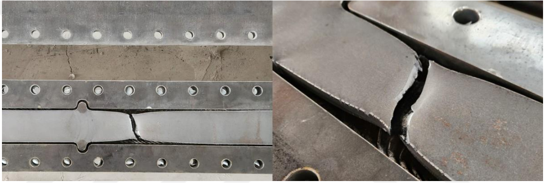
Şekil 4.15 BÖÇ-04 numunesinin çekirdek plakasında meydana gelen kopma fotoğrafı
