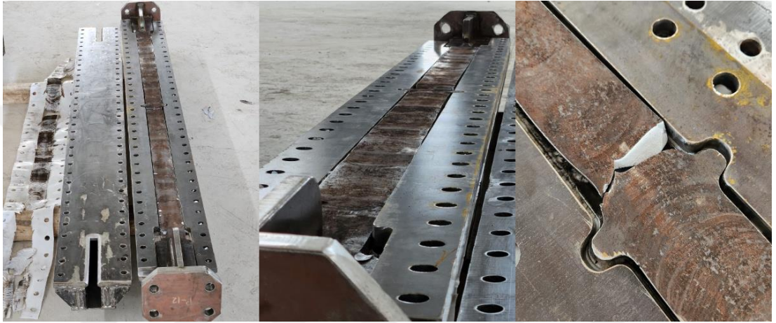
Şekil 4.3 BÖÇ-01 numunesinin çekirdek plakasında meydana gelen kopma fotoğrafı
