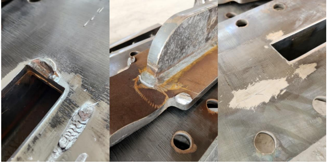
Şekil 4.59 BÖÇ-15 numunesinin sürtünmeye bağlı deformasyon izleri
