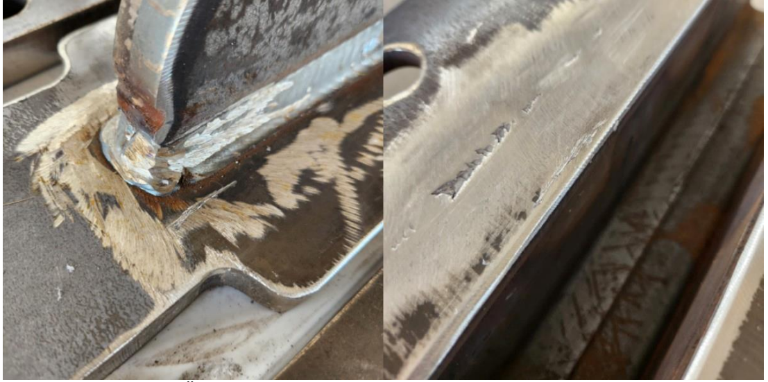
Şekil 4.54 BÖÇ-14 numunesinin sürtünmeye bağlı deformasyon izleri
