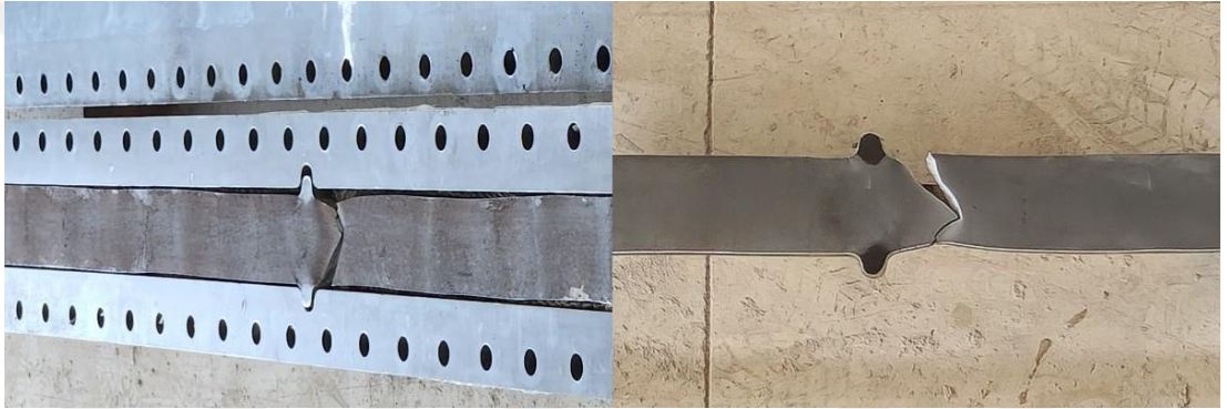
Şekil 4.43 BÖÇ-11 numunesinin çekirdek plakasında meydana gelen kopma fotoğrafı
