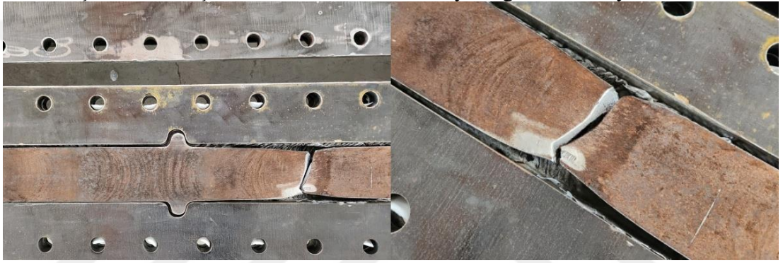
Şekil 4.7 BÖÇ-02 numunesinin çekirdek plakasında meydana gelen kopma fotoğrafı
