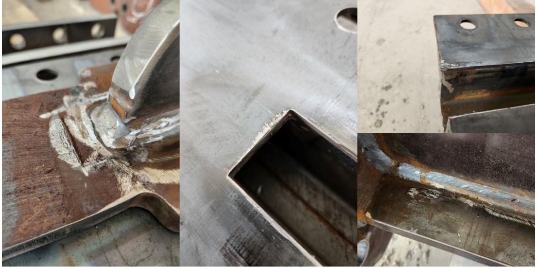
Şekil 4.34 BÖÇ-09 numunesinin sürtünmeye bağlı deformasyon izleri
