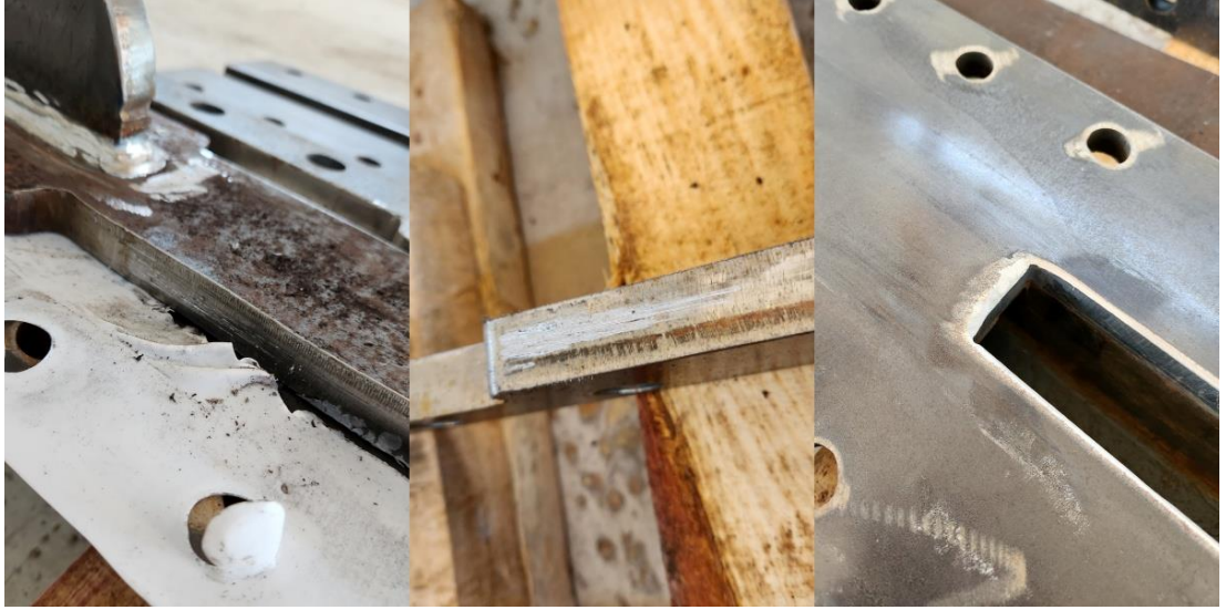
Şekil 4.10 BÖÇ-03 numunesinin sürtünmeye bağlı deformasyon izleri
