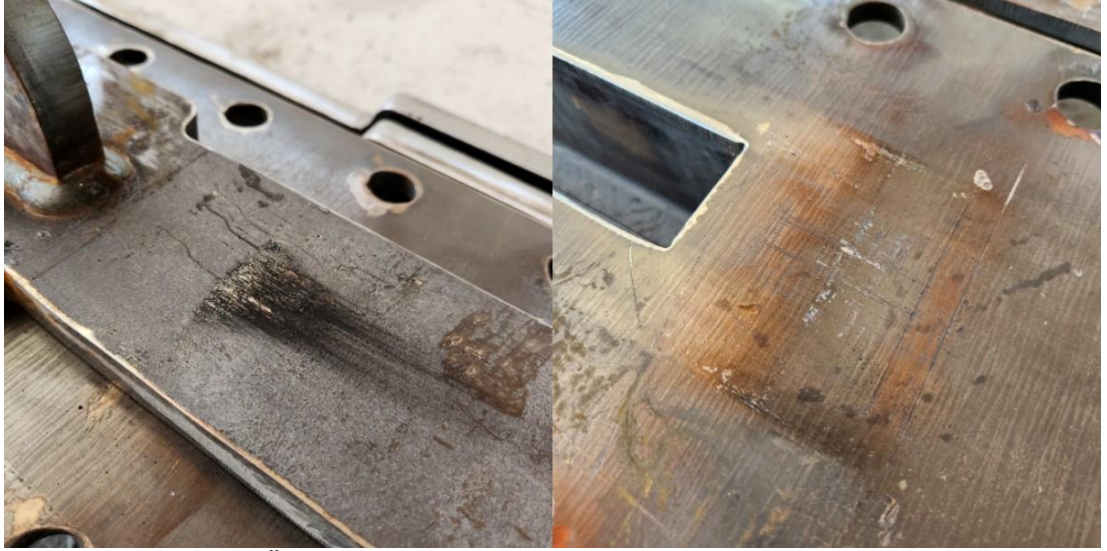
Şekil 4.46 BÖÇ-12 numunesinin sürtünmeye bağlı deformasyon izleri
