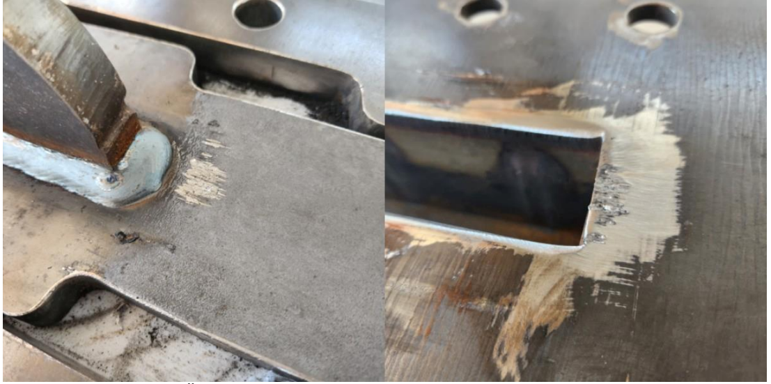
Şekil 4.50 BÖÇ-13 numunesinin sürtünmeye bağlı deformasyon izleri
