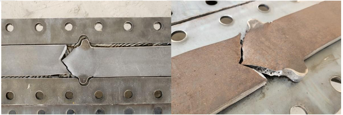
Şekil 4.39 BÖÇ-10 numunesinin çekirdek plakasında meydana gelen kopma fotoğrafı
