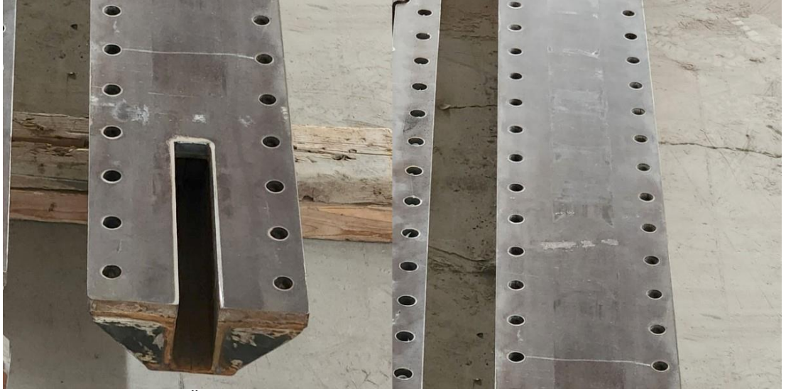
Şekil 4.14 BÖÇ-04 numunesinin sürtünmeye bağlı deformasyon izleri
