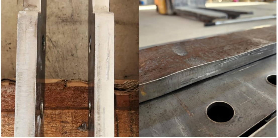
Şekil 4.38 BÖÇ-10 numunesinin sürtünmeye bağlı deformasyon izleri
