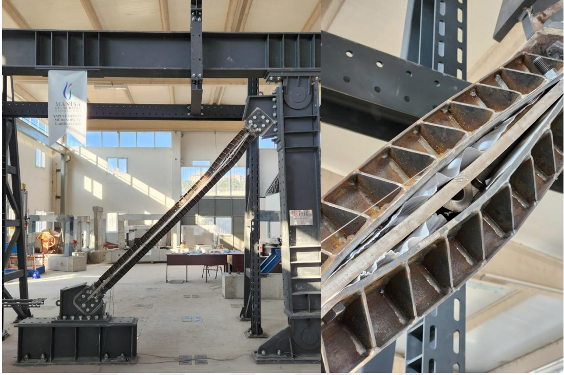
Şekil 4.58 BÖÇ-15 numunesinde gözlemlenen BÖM açılması
