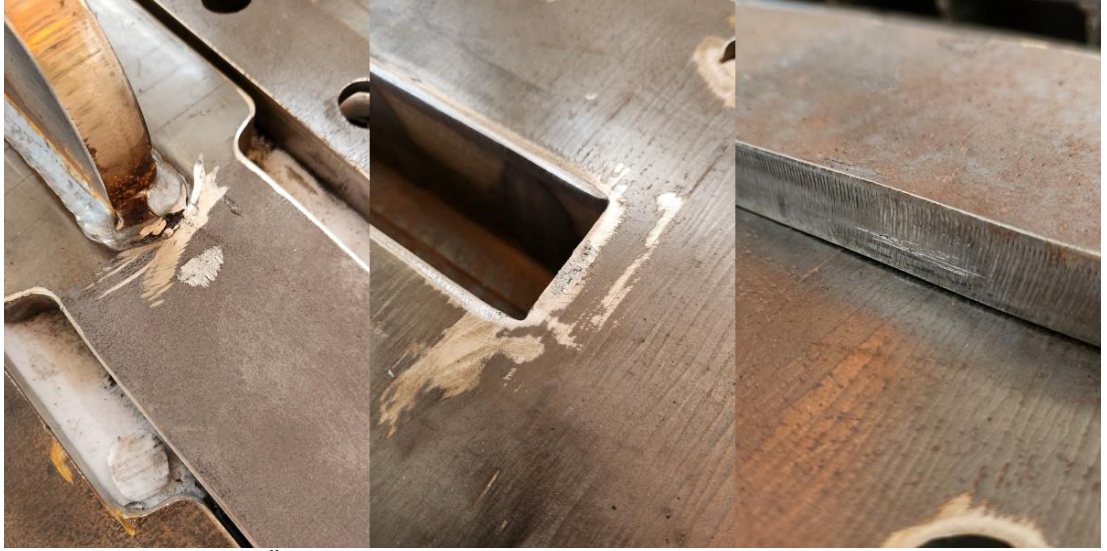
Şekil 4.30 BÖÇ-08 numunesinin sürtünmeye bağlı deformasyon izleri
