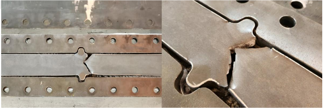
Şekil 4.31 BÖÇ-08 numunesinin çekirdek plakasında meydana gelen kopma fotoğrafı
