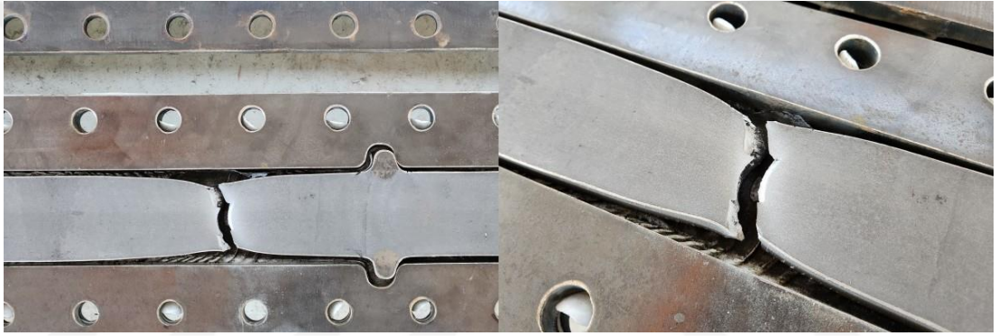
Şekil 4.19 BÖÇ-05 numunesinin çekirdek plakasında meydana gelen kopma fotoğrafı
