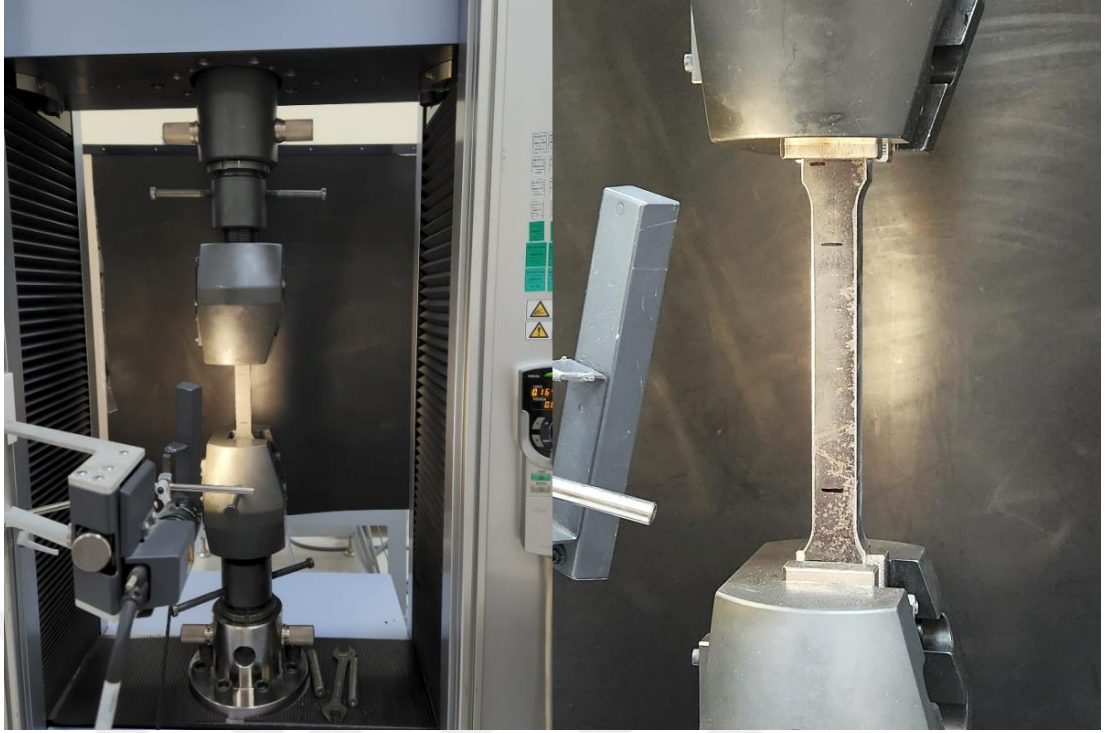
Şekil 3.5 Kupon numunelerinin deney düzeneğindeki görünüşü
