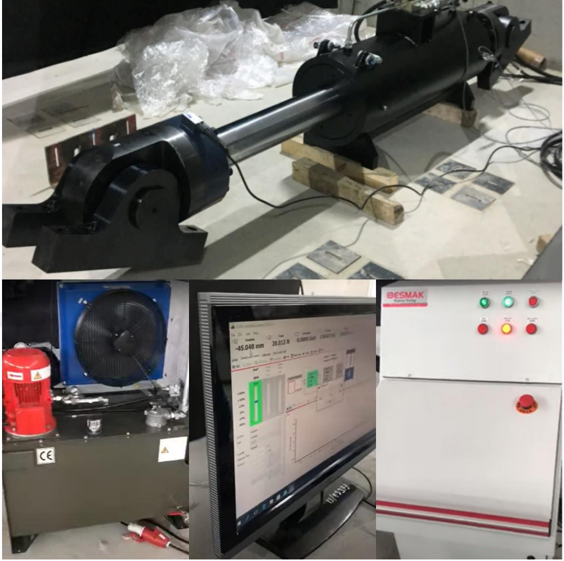
Şekil 3.2 Sırasıyla hidrolik piston, hidrolik ünite, kontrol yazılımı ve kontrol paneline ait görseller
