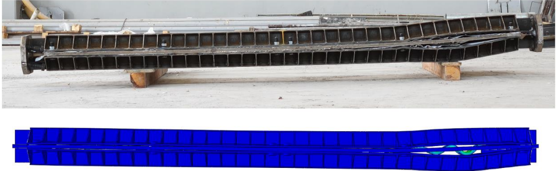
Şekil 4.71 Deney sonrasındaki deformasyonları ile analizden elde edilen deformasyon şeklinin karşılaştırmalı görseli
