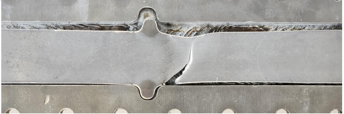
Şekil 4.35 BÖÇ-09 numunesinin çekirdek plakasında meydana gelen kopma fotoğrafı
