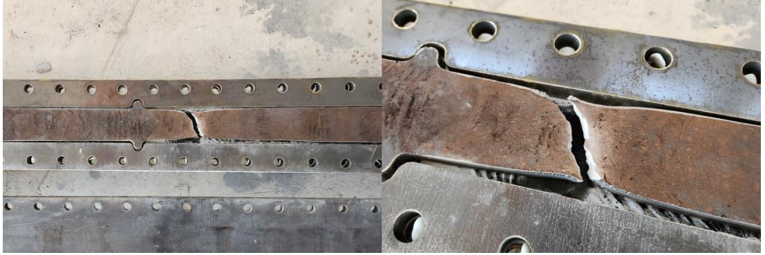
Şekil 4.11 BÖÇ-03 numunesinin çekirdek plakasında meydana gelen kopma fotoğrafı
