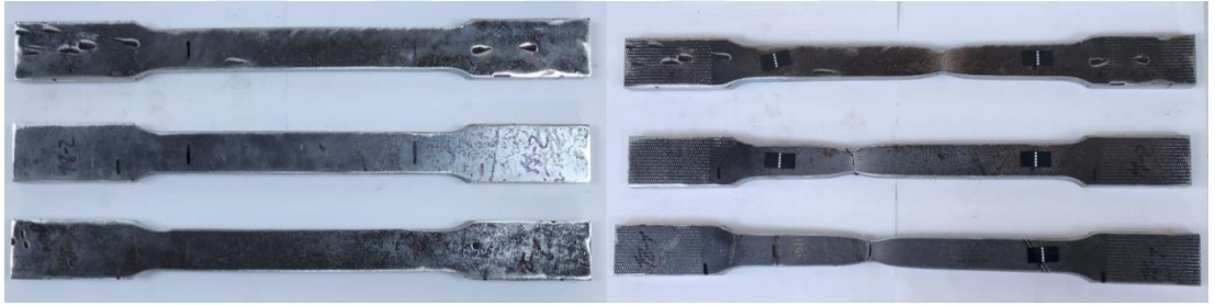
Şekil 3.6 Kupon numunelerinin kopma öncesi ve sonrası halleri
