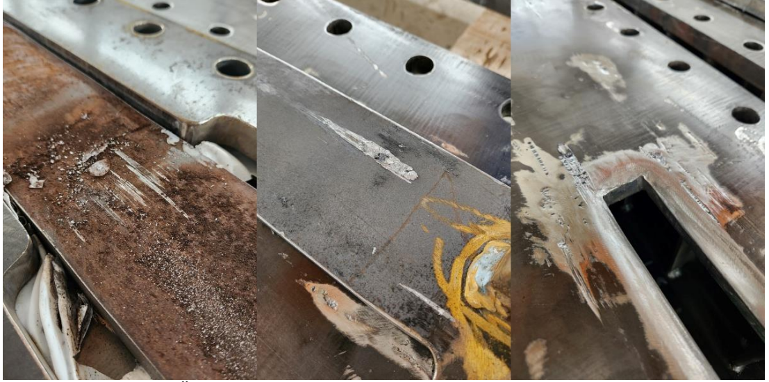
Şekil 4.6 BÖÇ-02 numunesinin sürtünmeye bağlı deformasyon izleri
