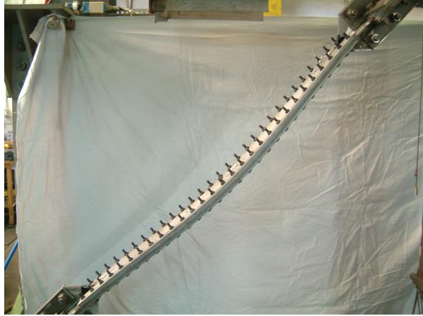
Şekil 2.12 F10W0-d1-6 ve F12W0-d1-2 numunelerinde gözlemlenen genel burkulma davranışı
