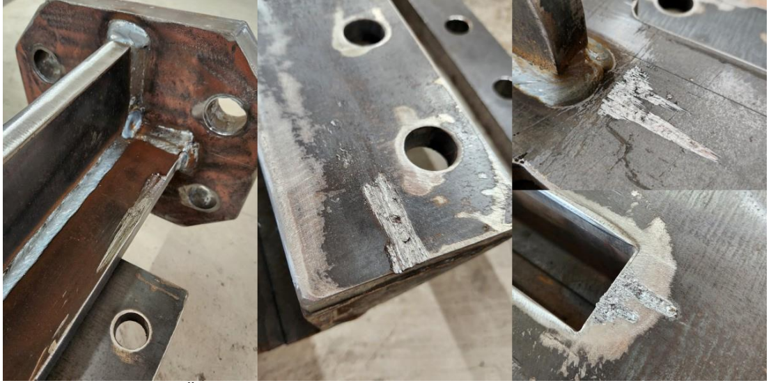
Şekil 4.22 BÖÇ-06 numunesinin sürtünmeye bağlı deformasyon izleri
