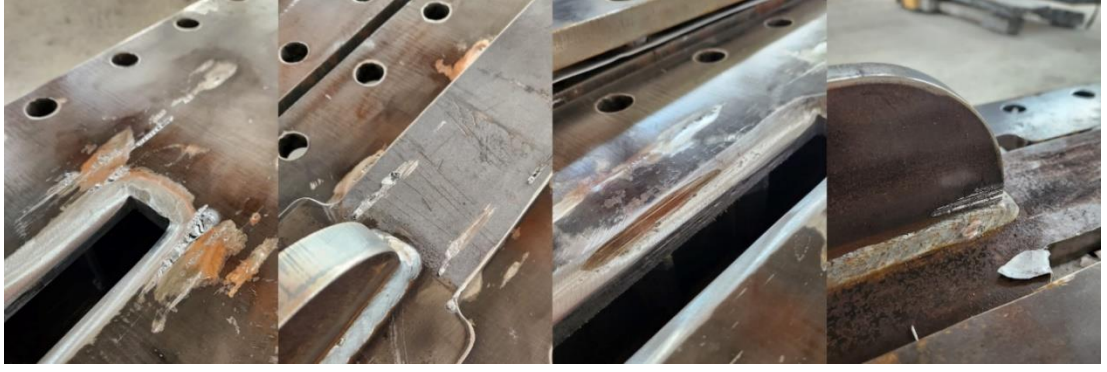
Şekil 4.2 BÖÇ-01 numunesinin sürtünmeye bağlı deformasyon izleri
