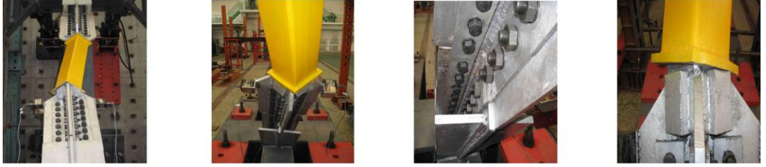
Şekil 2.18 Alt guse plakasında meydana gelen hasar fotoğrafları
