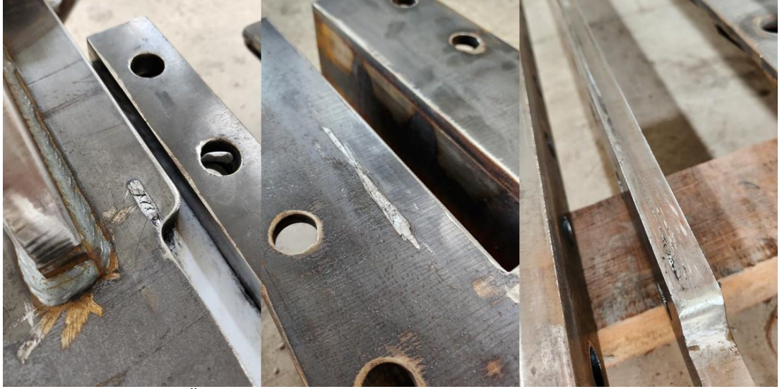
Şekil 4.26 BÖÇ-07 numunesinin sürtünmeye bağlı deformasyon izleri
