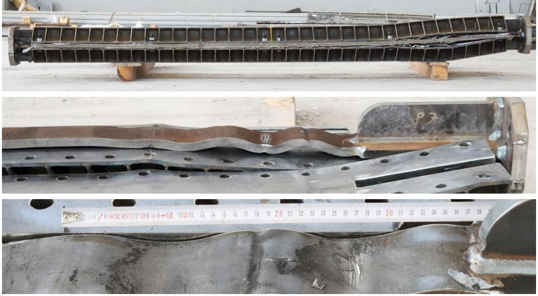
Şekil 4.60 BÖÇ-15 numunesinin çekirdek plakasında meydana gelen hasarlar
