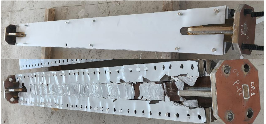
Şekil 3.13 Teflon plakanın deney öncesi ve sonrası durumunu gösteren görseller
