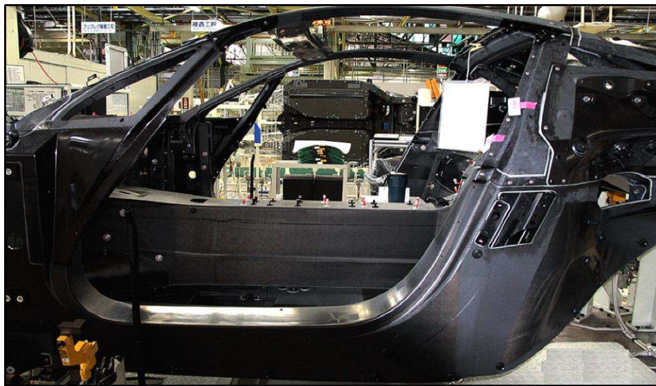
Şekil 2.6 Karbon-epoksi ile yapılmış bir spor otomobil şasesi
