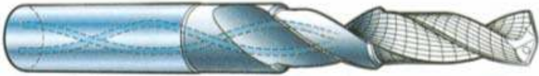
Şekil 3.18. Matkapla dahili kesme sıvısı temini [62].
