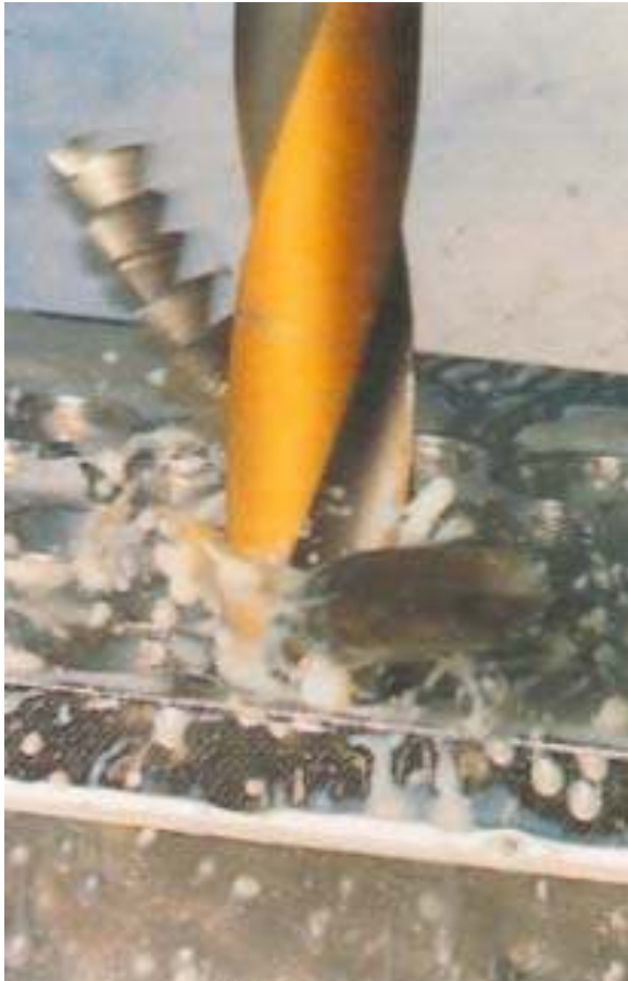
Şekil 3.1. Delik delme işlemi [62].
