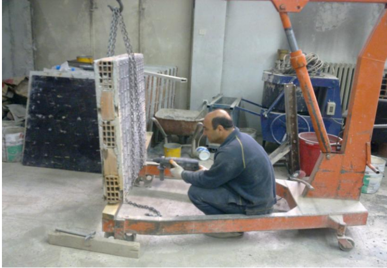
Resim 3.5. Deney elemanına deliklerin açılması
