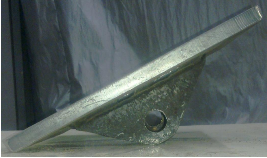
Resim 1.4. Deney çerçevesi alt ve üst mafsalsal mesnet ayağı
