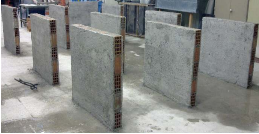
Resim 3.3. Güçlendirmeden önce deney elemanları
