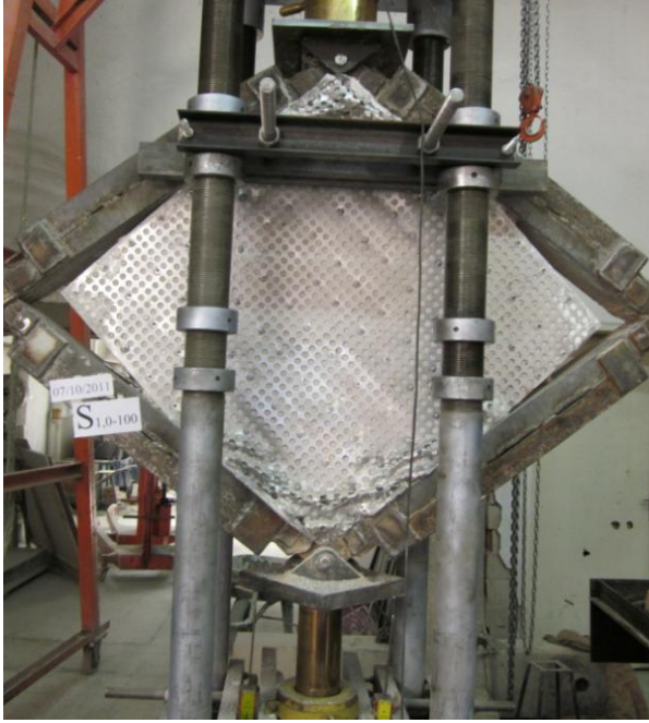
Resim 3.16. S1.0-100 deney elemanının deney sonundaki hasar durumu
