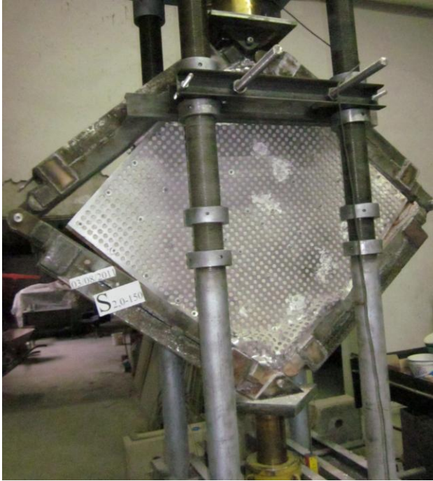
Resim 3.30. S2.0-150 deney elemanının deney sonundaki hasar durumu
