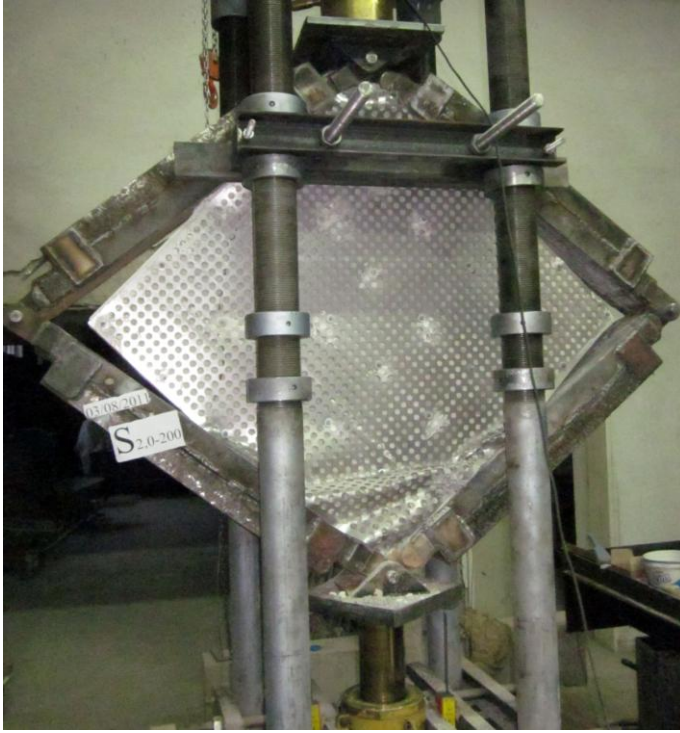
Resim 3.32. S2.0-200 deney elemanının deney sonundaki hasar durumu
