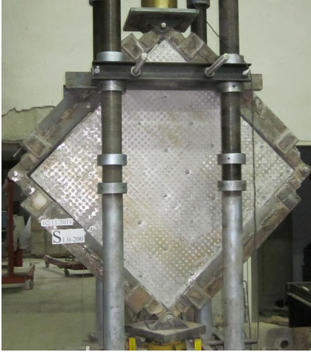
Resim 3.19. S1.0-200 deney elemanının deney öncesi durumu
