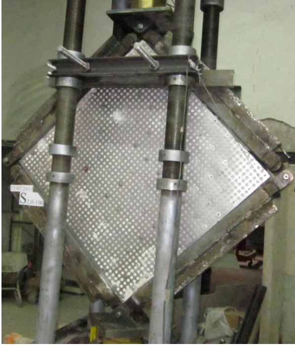
Resim 3.27. S2.0-100 deney elemanının deney öncesindeki durumu
