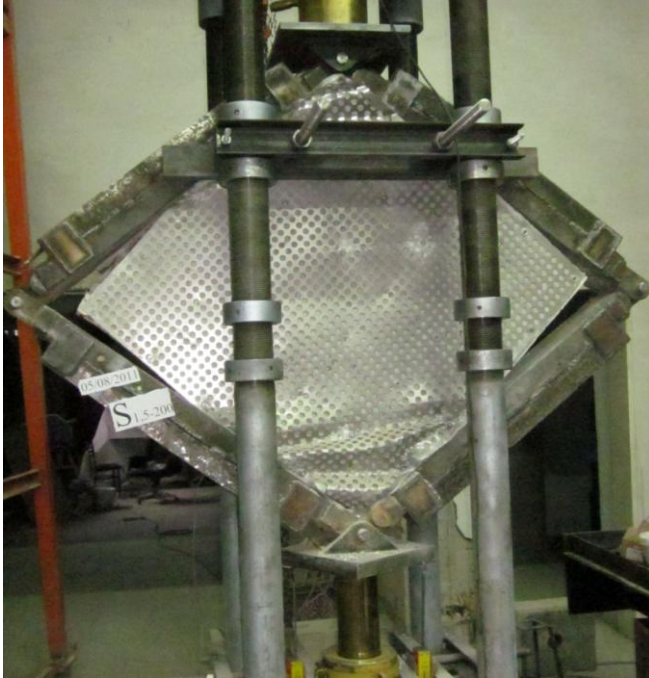
Resim 3.26. S1.5-200 deney elemanının deney sonundaki hasar durumu
