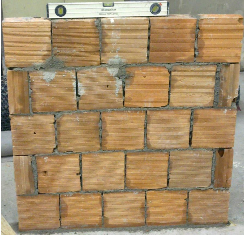
Resim 3.1 Yatay delikli tuğla ile örölmüş duvar
