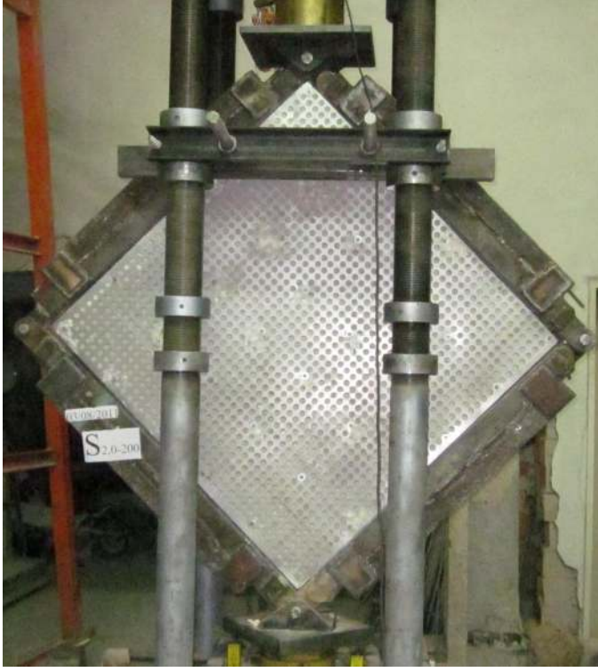
Resim 3.31. S2.0-200 deney elemanının deney öncesindeki durumu
