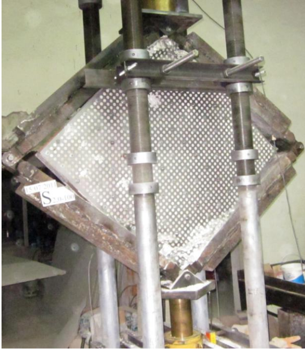
Resim 3.28. S2.0-100 deney elemanının deney sonundaki hasar durumu
