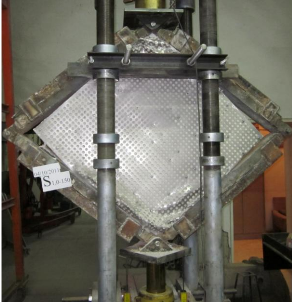
Resim 3.18. S1.0-150 deney elemanının deney sonundaki hasar durumu
