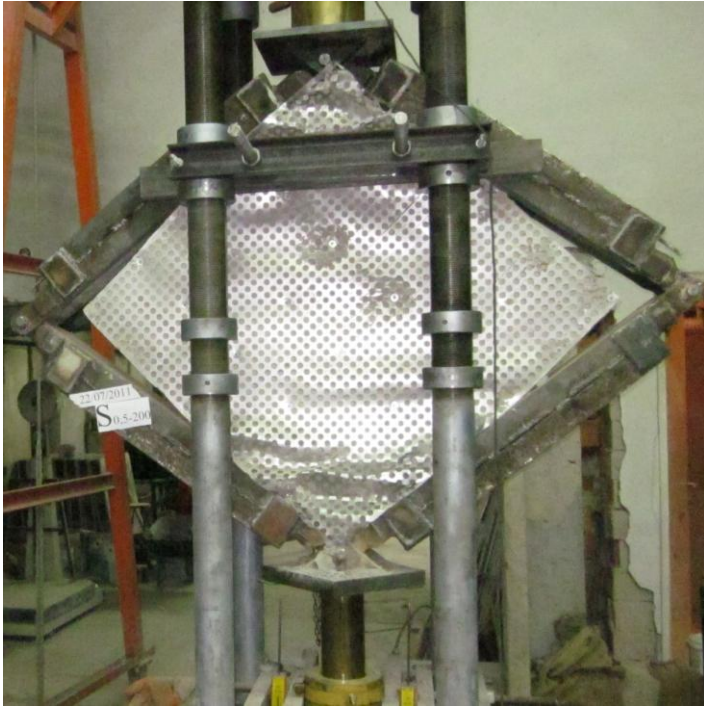
Resim 3.14. S0.5-200 deney elemanının deney sonundaki hasar durumu
