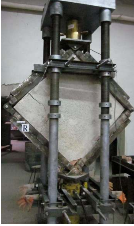
Resim 3.7. Referans deney elemanının başlangıç hasar durumu
