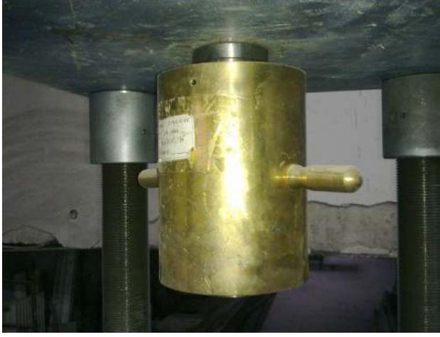
Resim 1.1. Yük hücresi (Load cell) ve bağlantı adaptörü
