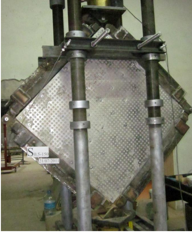
Resim 3.11. S0.5-150 deney elemanının deney öncesi durumu
