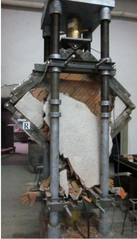
Resim 3.8. Referans deney elemanının deney sonundaki hasar durumu
