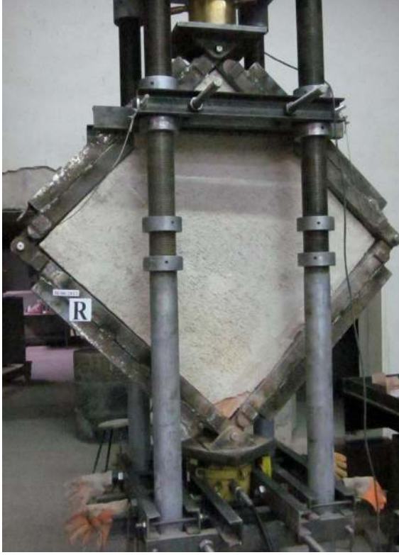
Resim 3.6. Referans deney elemanının deneyden önceki durumu
