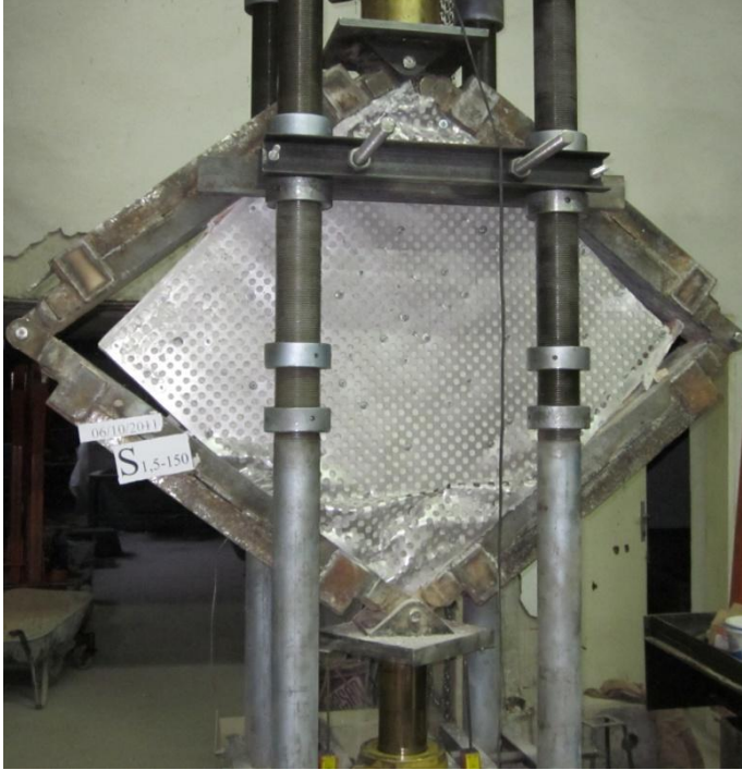
Resim 3.24. S1.5-150 deney elemanının deney sonundaki hasar durumu
