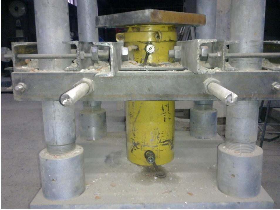
Resim 1.2. Hidrolik kriko sabitleme düzeneği ve kriko üstüne adaptörle yerleştirilen rijit plaka
