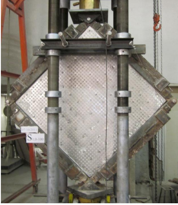
Resim 3.15. S1.0-100 deney elemanının deney öncesi durumu
