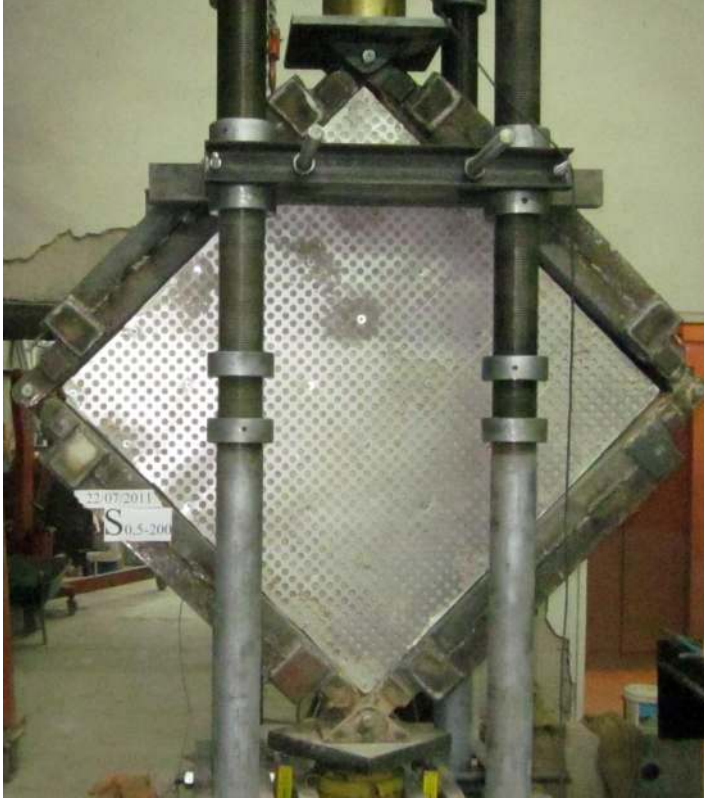
Resim 3.13. S0.5-200 deney elemanının deney öncesi durumu
