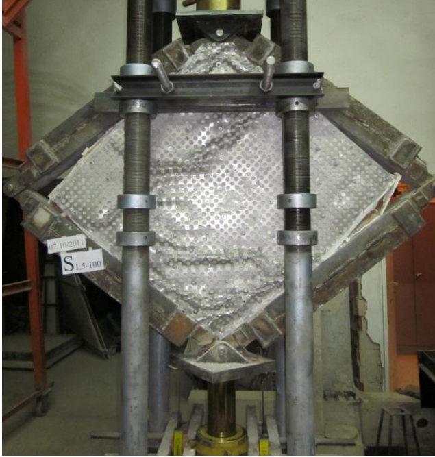
Resim 3.22. S1.5-100 deney elemanının deney sonundaki hasar durumu
