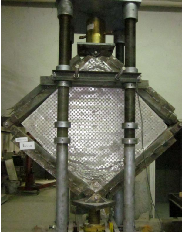
Resim 3.10. S0.5-100 deney elemanın deney sonundaki hasar durumu
