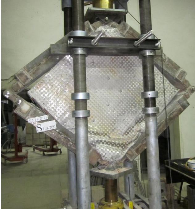
Resim 3.20. S1.0-200 deney elemanının deney sonundaki hasar durumu
