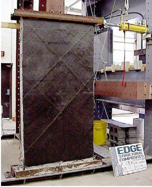
Resim 2.1. Karbon lifli polimer (CFRP) ile güçlendirme [5]
