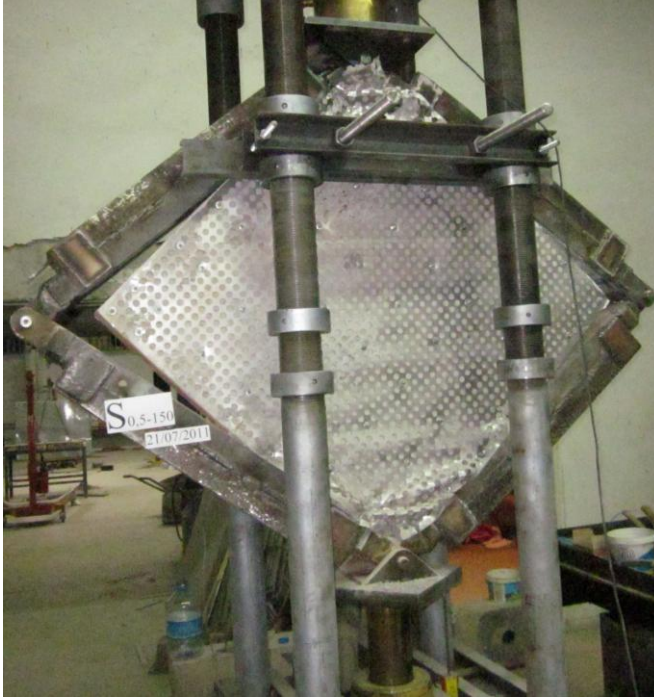
Resim 3.12. S0.5-150 deney elemanının deney sonundaki hasar durumu
