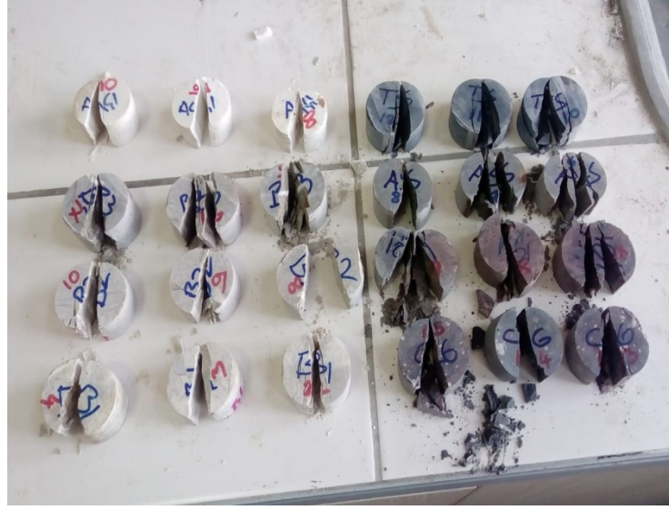
Şekil 5.6. Brazilian deneyinde kırılan numuneler.
