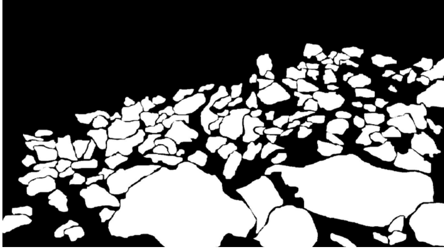
Şekil 5.15. TO-1 kodlu ocağın patlatma sonrası oluşan fotoğrafın işlenmiş hali.
