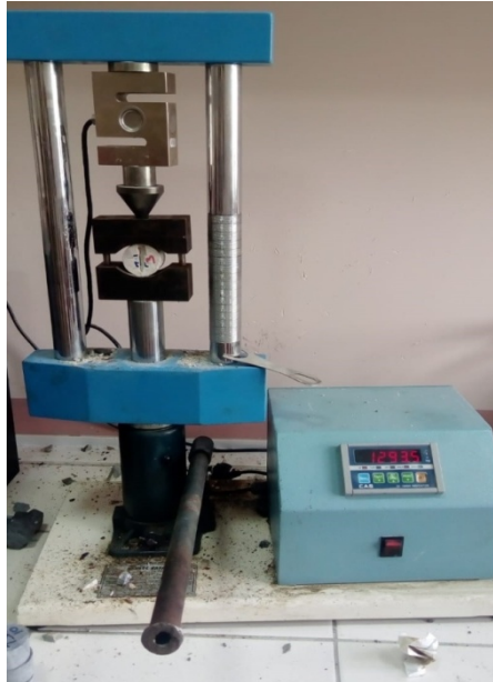
Şekil 5.5. Brazilian (dolaylı çekme) deney aleti.
