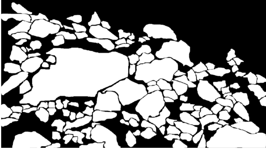
Şekil 5.27. TO-4 kodlu ocağın 2. patlatma sonrası oluşan fotoğrafın işlenmiş hali.
