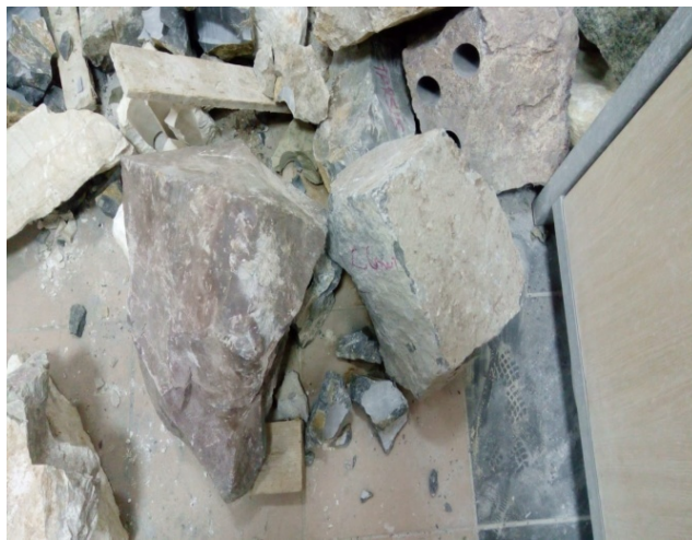
Şekil 5.9. Schmidt çekici deneyi için blok numuneler.
