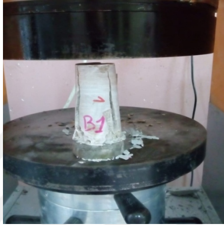
Şekil 5.13. Tek eksenli basınç dayanımı deneyi esnasında kırılan numune.
