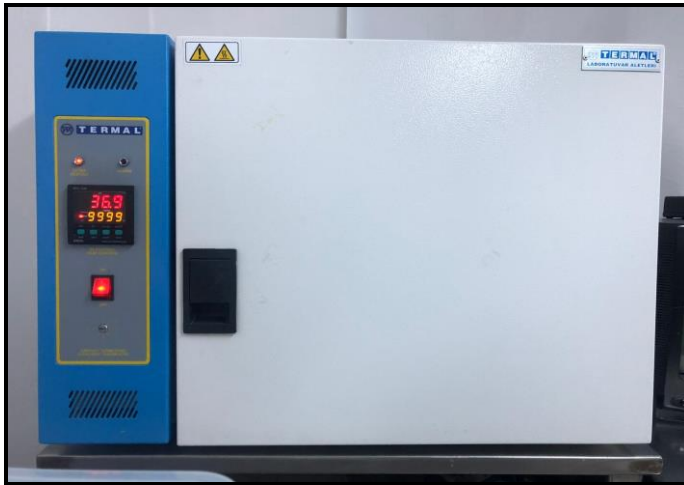
Şekil 3-3: Dişlerin demineralizasyon aşamasında bekletildiği inkübatör cihazı
