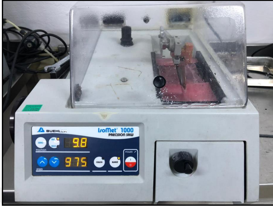
Şekil 3-12: Dişleri kesmek için kullanılan düşük hızlı elmas testere cihazı (IsoMet 1000, Buehler Inc., UK)
