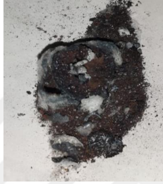
Şekil 7.16 \text{FeO/C}=80/20 , olarak hazırlanan peletlerin mikrodalga redüksiyon işleminden sonraki görüntüleri
