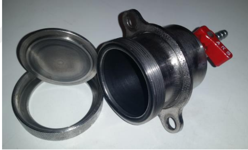
Şekil 6.16. Deneylerde kullanılmak üzere özel olarak üretilmiş 56 mm derinlik, 48 mm iç çap ve 7 mm et kalınlığına sahip Spex haznesi
