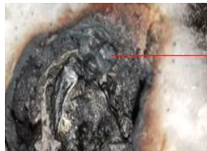
Şekil 7.17 \text{FeO/C}=70/30 olarak hazırlanan peletlerin mikrodalga redüksiyon işleminden sonraki görüntüleri
