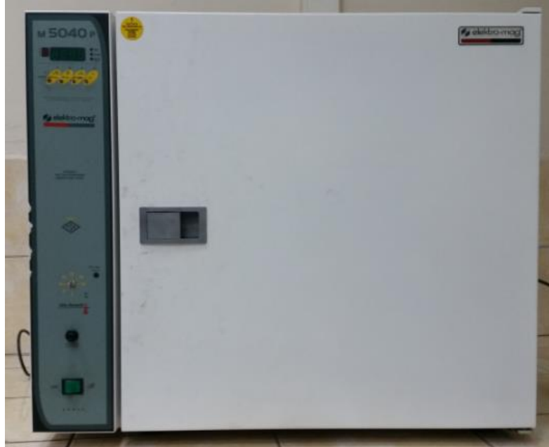
Şekil 6.10. Peletlerin Kurutulduğu Etüv
