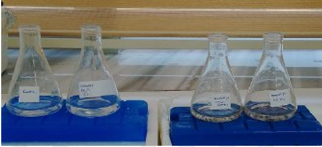
Şekil 4. 26. Serbest ve İmmobilize BCA'nın, CO 2 giderim potansiyeli için 4 farklı reaksiyon karışımı
