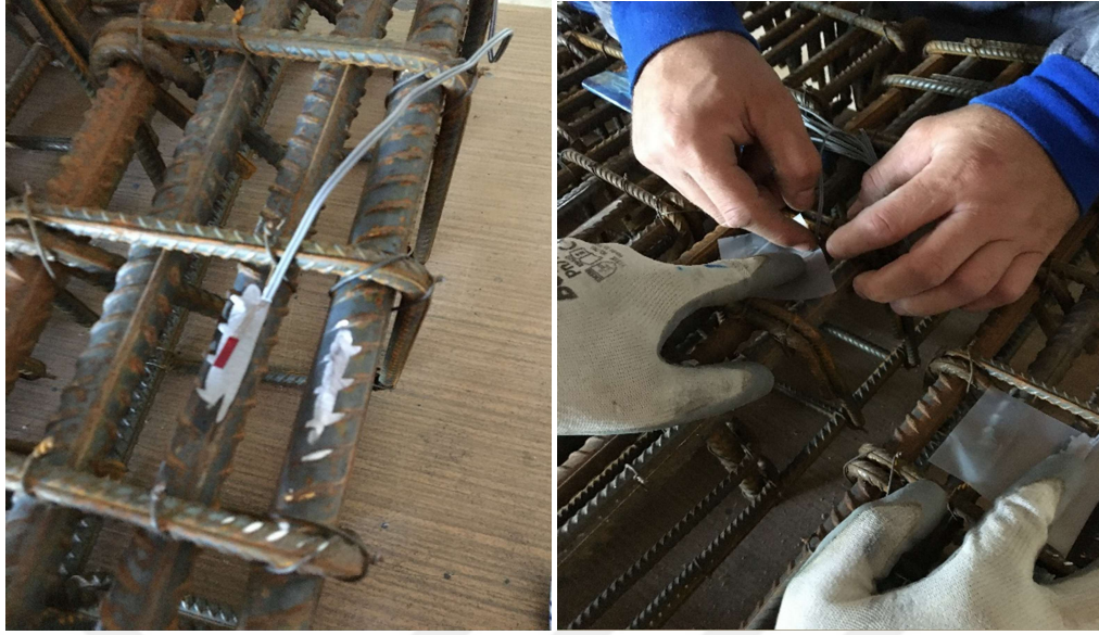
Şekil 4.4. Strain-gauge (gerinim ölçer) yerleştirilmesi
