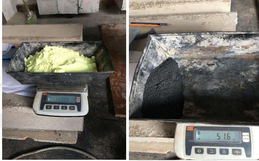
Şekil 4.14. Kükürt - grafit hassas terazide tartılması
