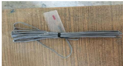
Şekil 4.23. Strain-gauge (gerinim ölçer) resmi
