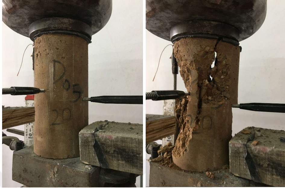
Şekil 4.17. Silindir numune basınç deneyi
