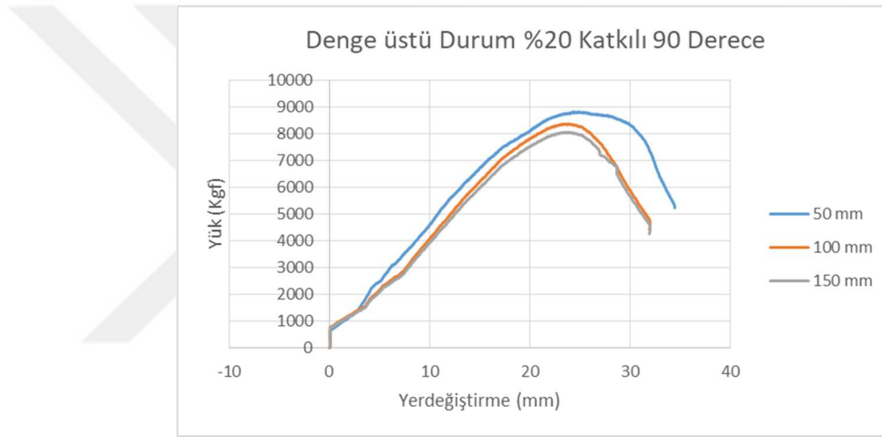
Şekil 6.5. Denge üstü durum-%20 Katkılı-90 Derece Kanca Açılı Numunelerin Karşılaştırmalı Grafiği
