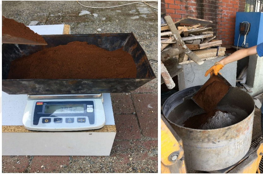
Şekil 4.8. Demir tozu tartılıp eklenmesi
