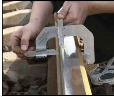
Şekil 1.1. El ile ölçüm için ray profil ölçüm aleti [6].
