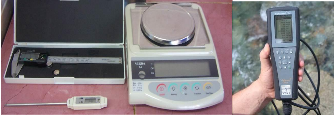
Şekil 2.8. Kullanılan alet ekipmanlar (Dijital kumpas, hassas terazi, termometre ve YSI)
