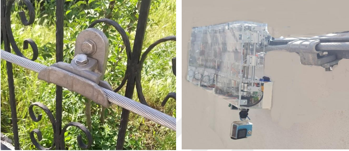
Şekil 3. 11 Topraklama telini sabit tutan bağlantı malzemesi (engel) ve robot montajı.
