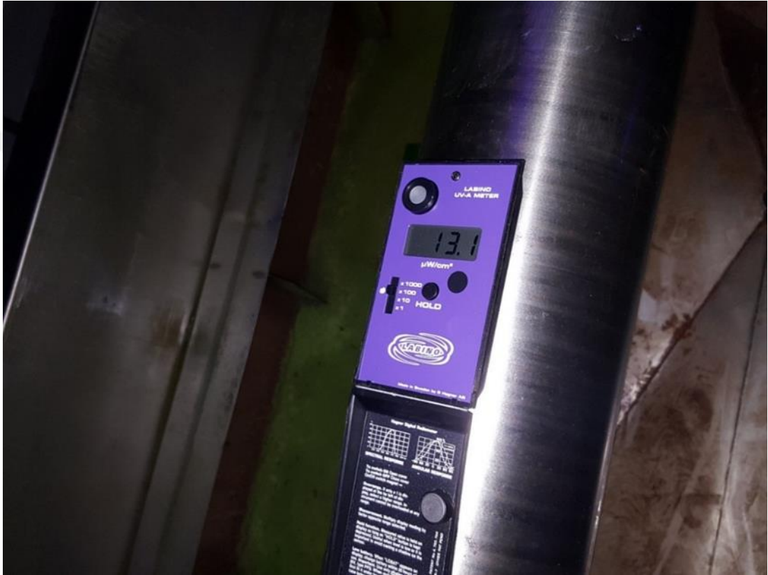
Şekil 5.24.UV ışığın aks üzerine yansıyan UV-A şiddetinin ölçümü.
