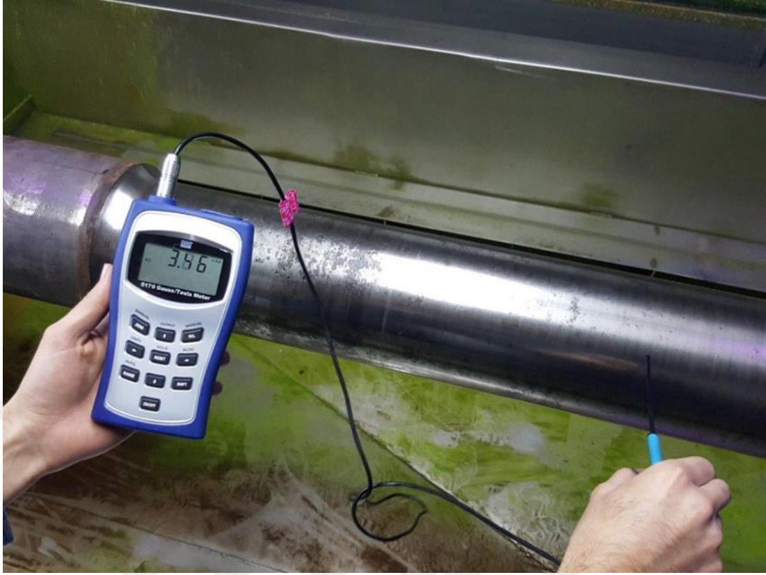
Şekil 5.25. Aks üzerinden geçen teğetsel alan kuvvetinin ölçümü.
