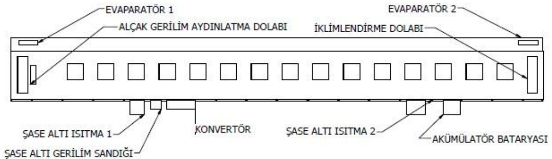
Şekil 3.1. TVS 2000 tipi çekilen araç klima sistemi parçaları
