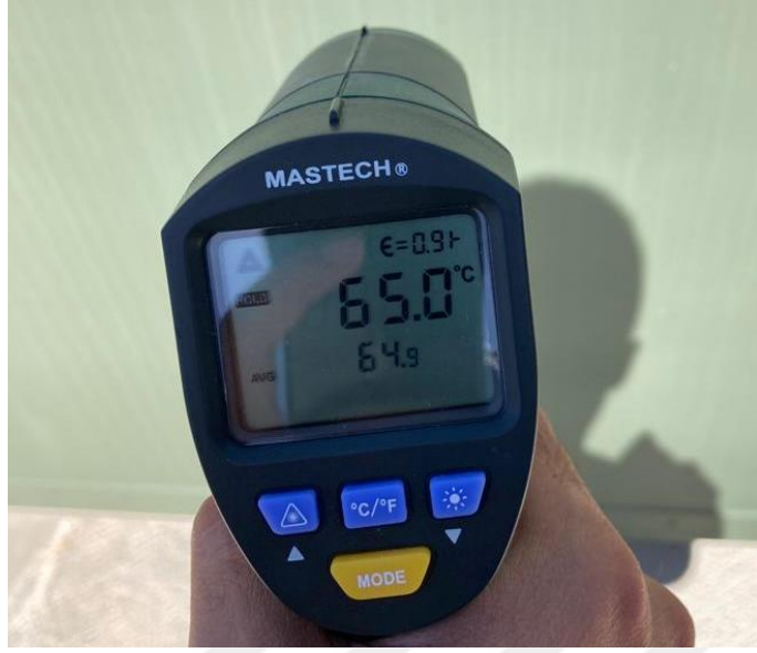
Şekil 4.6. MASTECH MS6540B lazer ölçüm cihazı ile benzer bir ürünün güneş altında sıcaklık ölçümü
