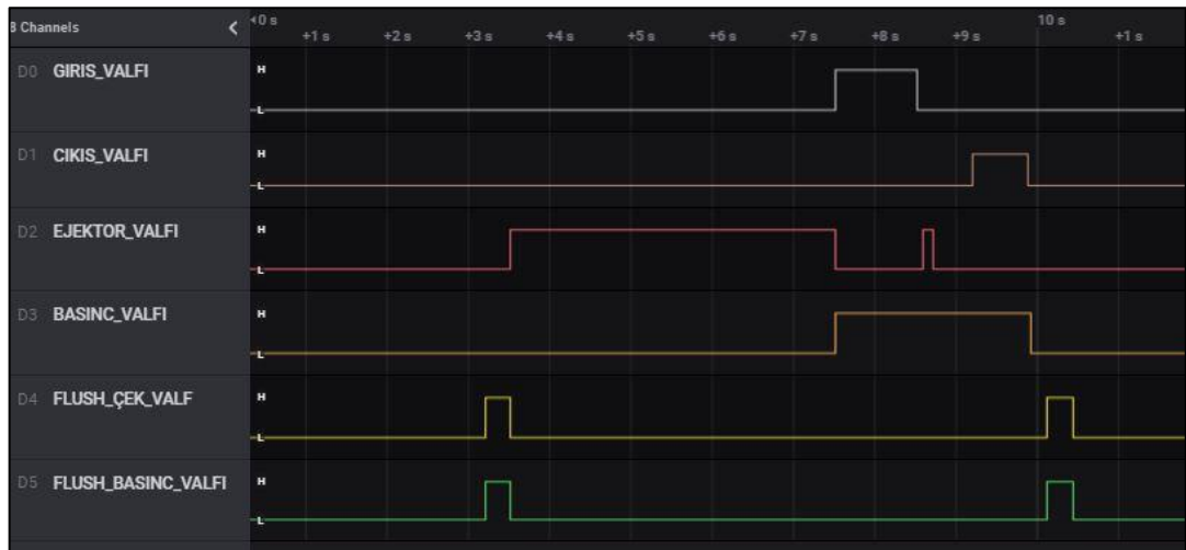
Şekil 3.9. Yıkama fonksiyonu valflerinin çalışma diyagramı.
