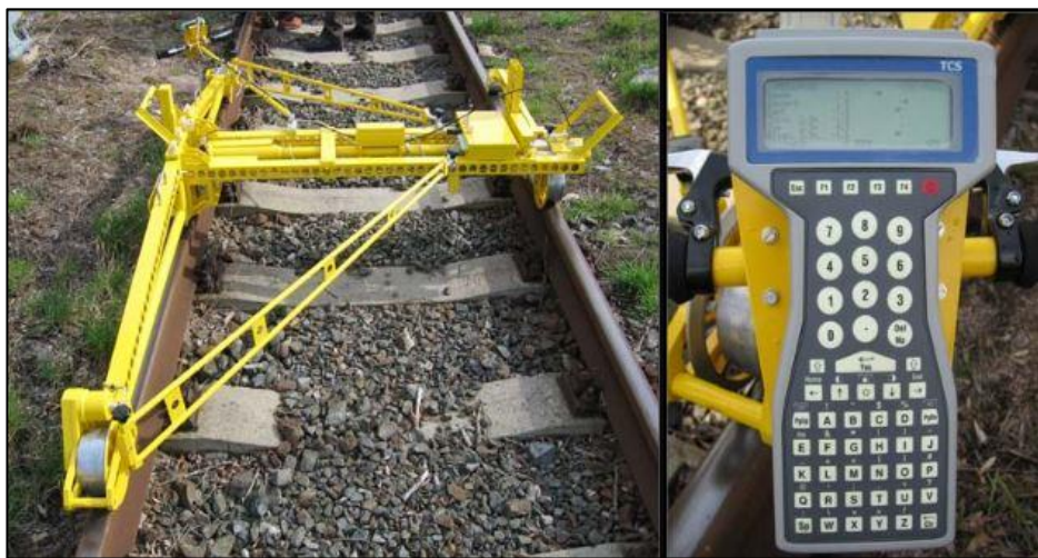
řekil 7.7. Hat geometrisi lm cihazı ve el bilgisayarı [50]
