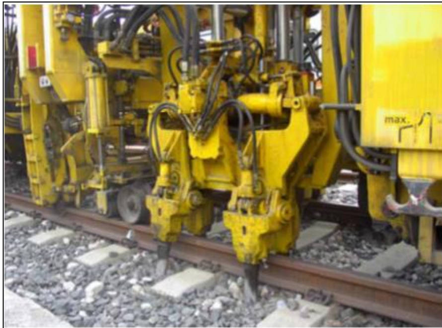
Şekil 6.1. Buraj makinesi çalışırken [39]
