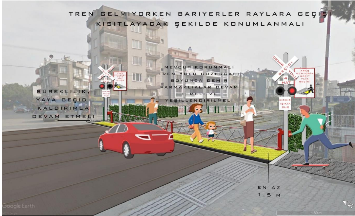
Şekil 4. 2. 2 numaralı hemzemin geçit örnek tasarımı – tren geçmiyorken (doğu tarafı)
