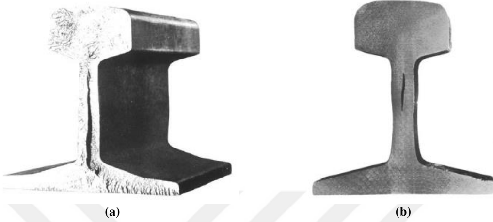
Şekil 2.23. Ray gövdesinde oluşan düşey çatlak görüntüsü [124] (a) UIC 133 (b) UIC 233.
