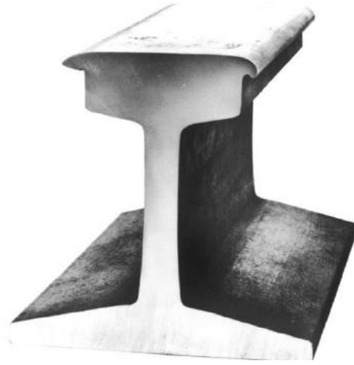
Şekil 2.15. Ray mantarında oluşan düşey aşınma arızasına ait görüntü [124]
