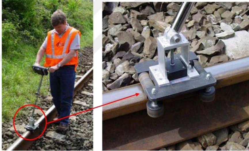
Şekil 2.29. Demiryolu hattında rayların girdap akımları yöntemi ile muayene edilmesi [129]
