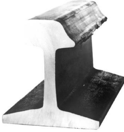
Şekil 2.14. Ray mantarında oluşan yanal aşınma arızasına ait örnek görüntü [124].
