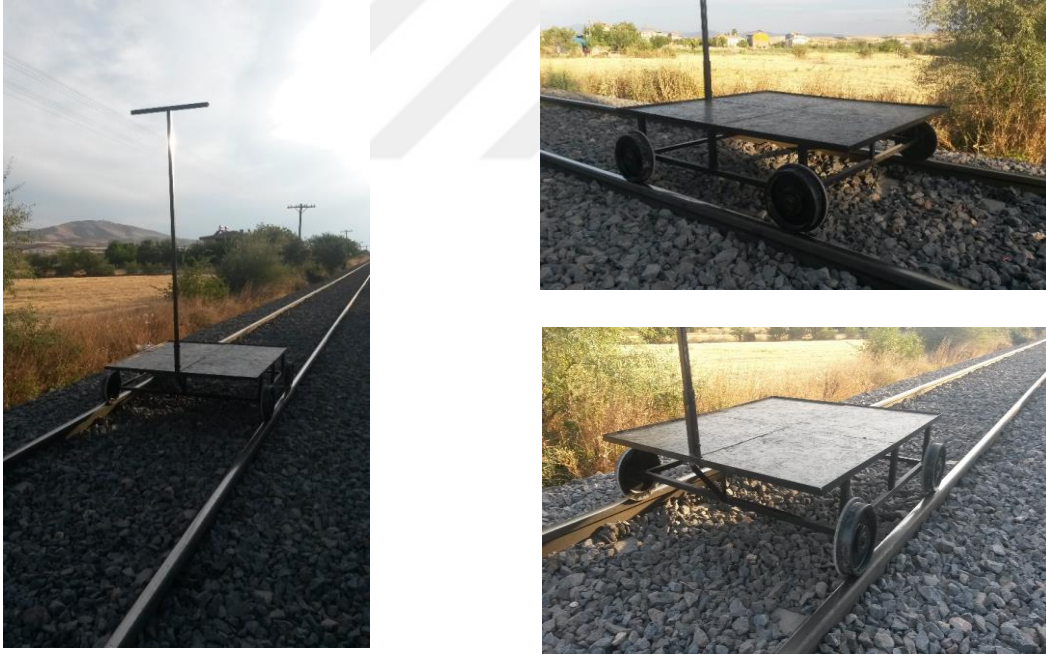
Şekil 4.4. Demiryolu aracının demiryolu hattı üzerine yerleştirilmiş görüntüleri
