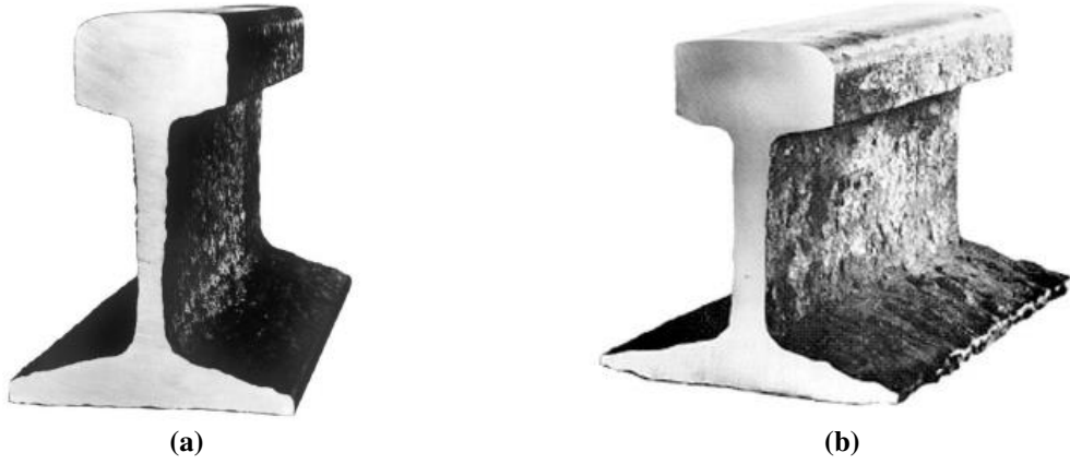
Şekil 2.24. Ray tabanında oluşan korozyon arızası görüntüsü [124] (a) UIC 234 (b) UIC 254
