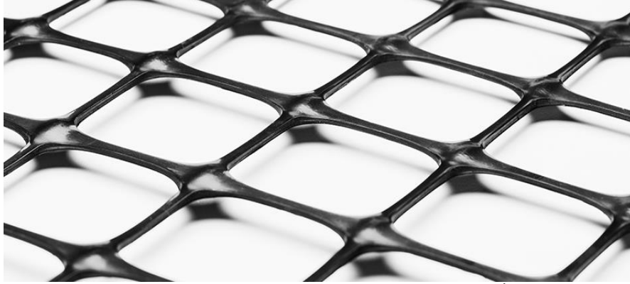
Resim 3.2 Çift eksenli ekstrüde yöntemi ile üretilmiş geogrid örneği (İnt. Kyn. 12).
