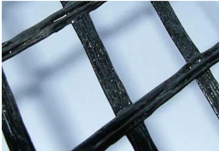
Resim 3.5 Dokuma yöntemi ile üretilmiş geogrid örneği (İnt. Kyn. 13).
