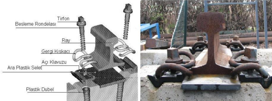
Resim 4.8 Rayı traverse bağlayan “HM” tipi bağlantı (İnt. Kyn. 19).
