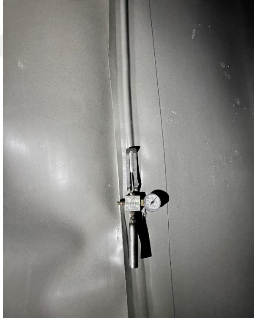
Resim 2.10 Geomembran hava basınç testi uygulaması.
