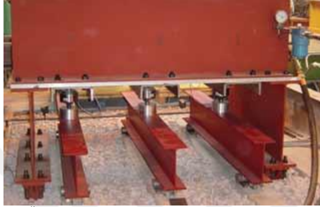
Resim 3.19 Nottingham Üniversitesi Rail Test simüle edilen tren yükü düzeneği (Tensar 2014).
