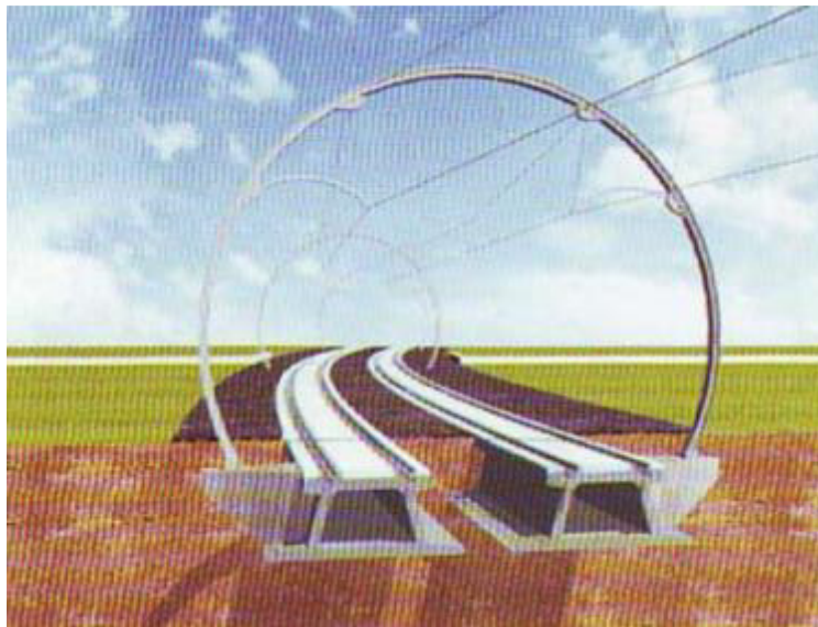
Şekil 2.44: Deck Track üstyapı sistemi [5].
