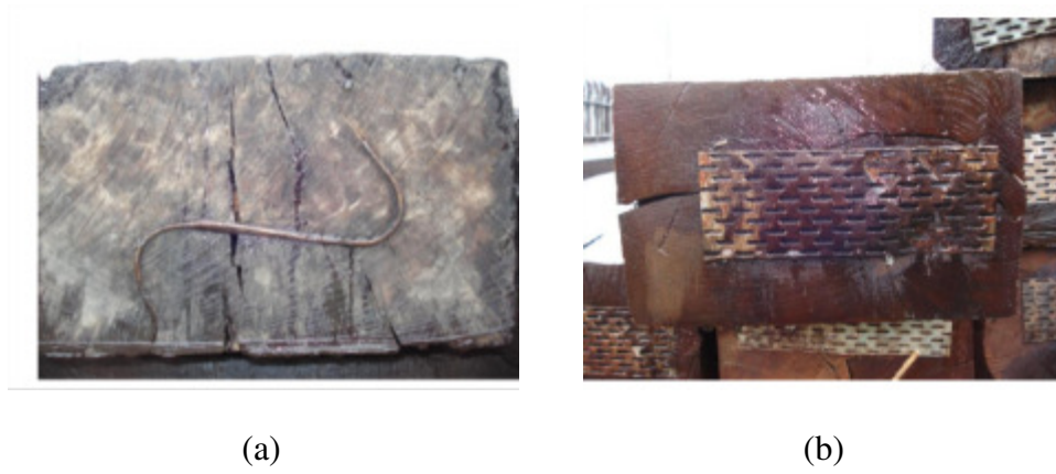
Şekil 3.12: Ahşap travers koruma yöntemi a) S demiri b) Delikli plaka [15].
