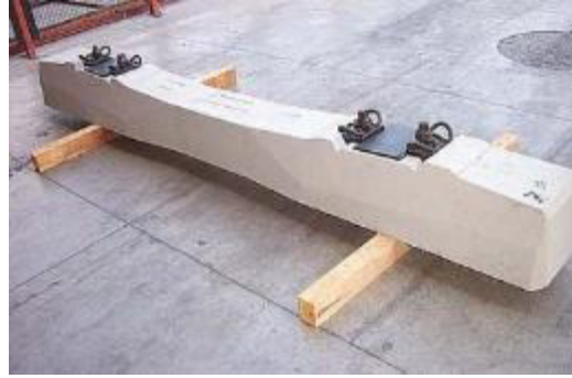
Şekil 3.15: B70 tipi monoblok beton travers [18].
