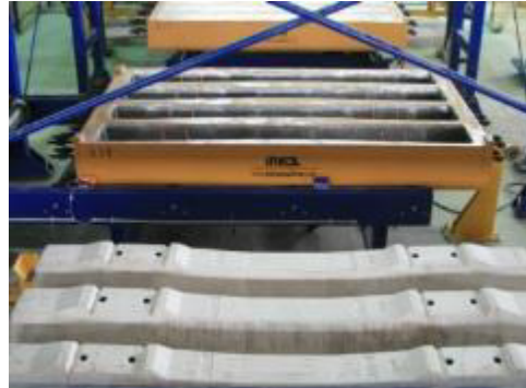
Şekil 3.17: Artgermeli travers üretimi [20].
