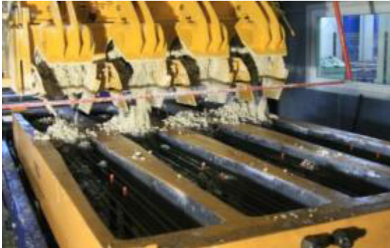
Şekil 3.17: Artgermeli travers üretimi [20].
