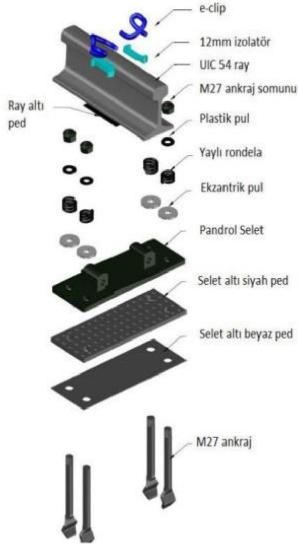
Şekil 3.9: Pandrol bağlantı elemanı (yaylı bağlantı) [14].
