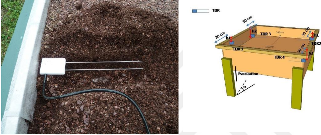
Şekil 2.16. TDR CS616 campbell scientific (sol) ve lizimetredeki konumları (sağ) (Yılmaz vd., 2016)
