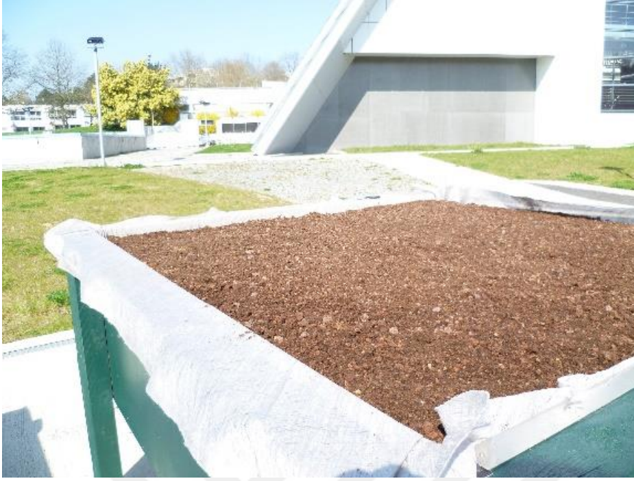
Şekil 2.13. Deneysel lizimetre üzerine yerleştirilmiş 12 cm lik yetiştirme katmanı (Yılmaz vd., 2016)
