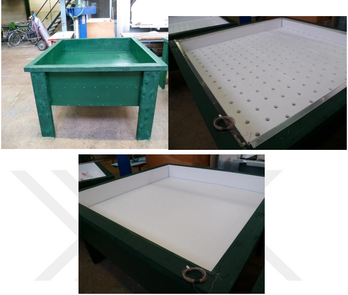
Şekil 2.11. Deneysel lizimetre boya ve polistiren katman kaplanması (Yılmaz vd., 2016)
