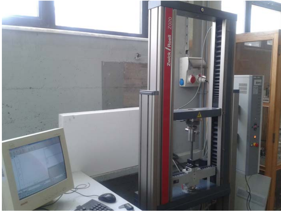
Resim 9: Zwick/Roell Z020 marka biyomekanik test cihazı
