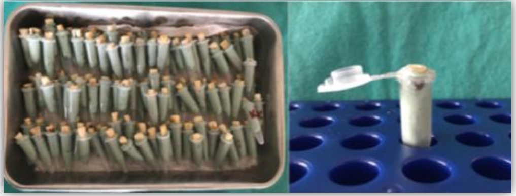
Şekil 3.4. Silikon ölçü maddesi ile modifiye edilmiş tüplere yerleştirilmiş diş örnekleri.
