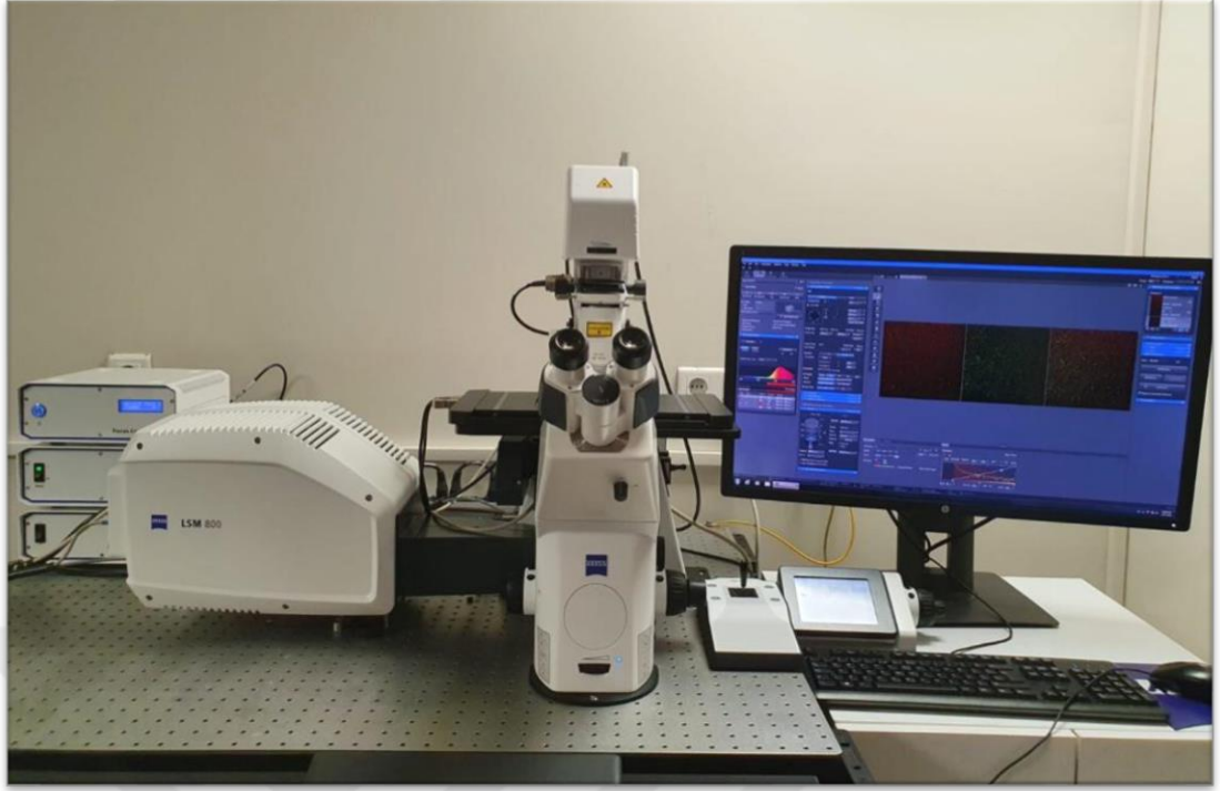
Şekil 3.20. Zeiss LSM 880 konfokal mikroskop (Carl Zeiss, Almanya).
