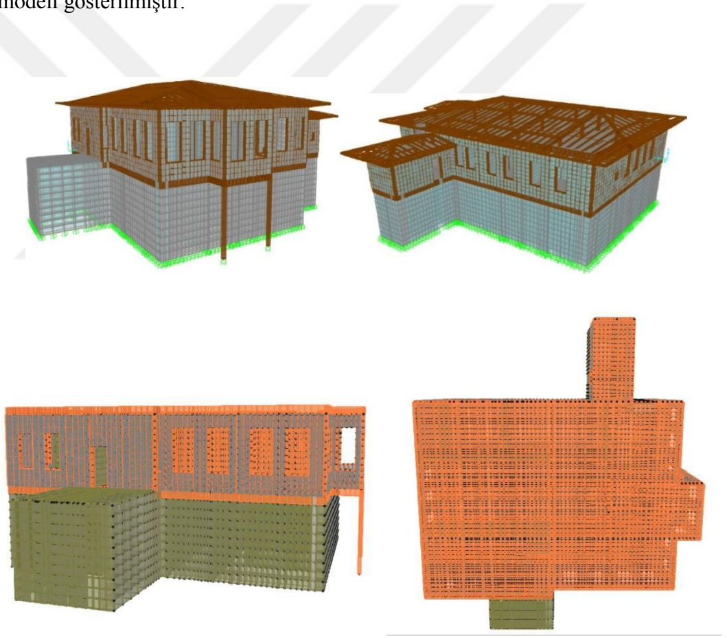
Şekil 2.15. Tarihi hımış konağın SAP2000 sonlu eleman modeli
