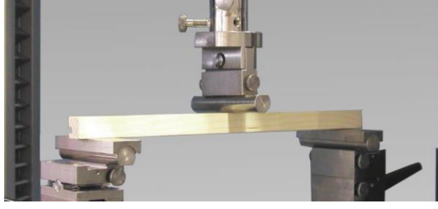
Şekil 1.4. Liflere dik yönde eğilme dayanımı deneyi (URL-7).
