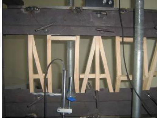
Şekil 1.2. Basit bir ahşap iskelet sistemin basınç deneyi (Uzunoğlu vd., 2009).
