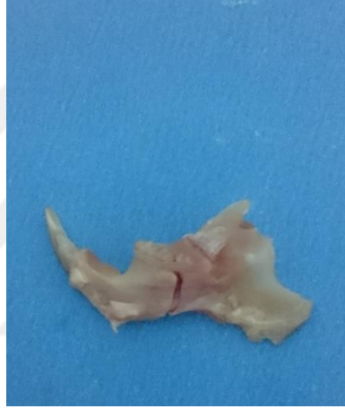
Şekil 17. Deney sonrası kırılmış mandibula (kırık hattı izlenmektedir)
