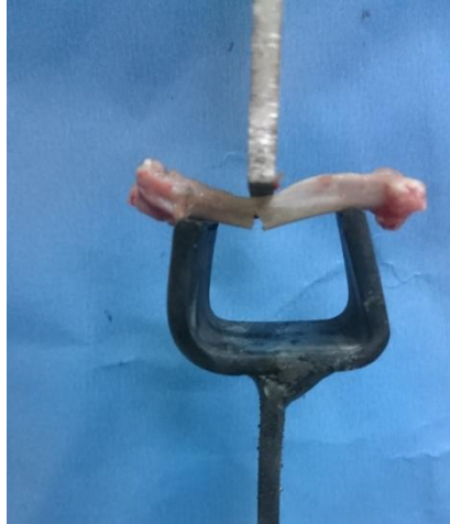
Şekil 15. Kırılmadan sonra femur görüntüsü
