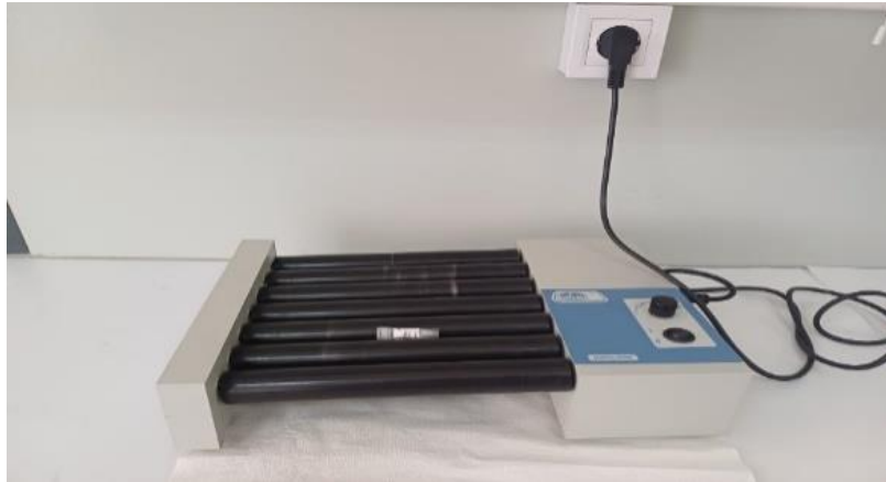
Şekil 3.17. Yatay karıştırıcıda standartların homojen hale getirilmesi
