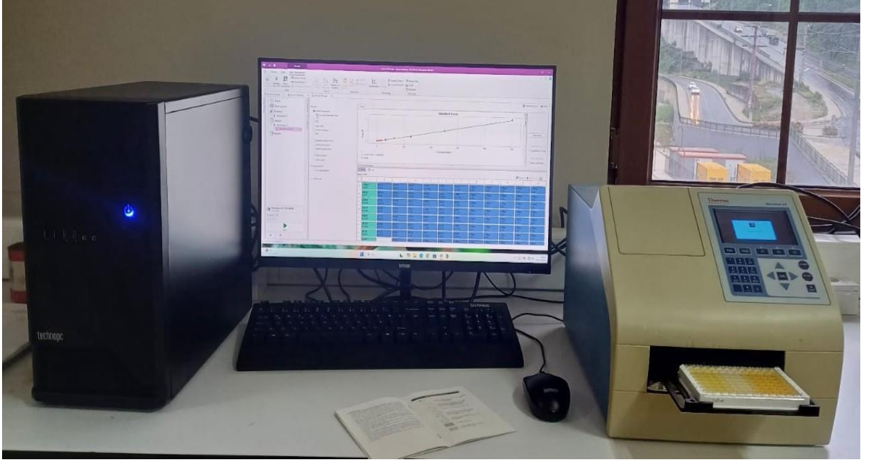
Şekil 3.12. Thermo Scientific, Multiskan GO cihazında mikrolakanın okunması, standart grafiklerin çizimi ve sonuçların hesaplanması
