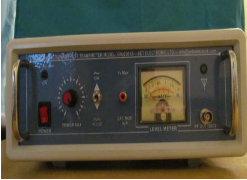
Şekil 6a; Elektromanyetik alan oluşturmak üzere kullanılan frekans jeneratörü
