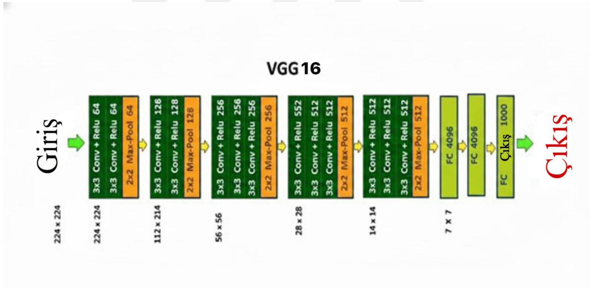
Şekil 11. VGG16 mimarisi (Rangari vd., 2023)
