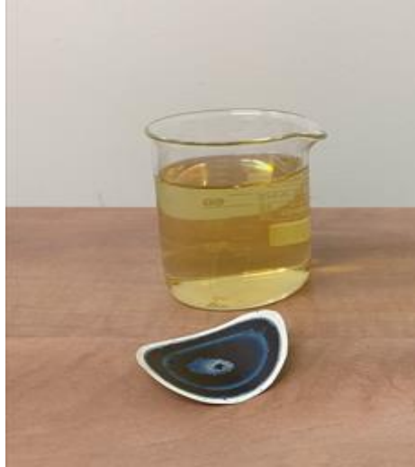
Şekil 4.42. UF Süzüntü Suyu ve UF Membran Görünümü
