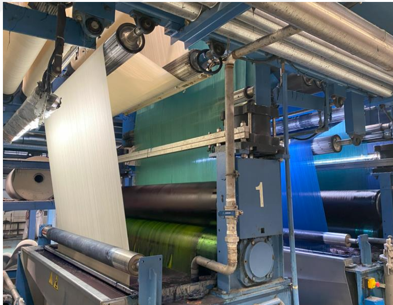
Şekil 4.14. İndigo Boyar Maddesi İle Boyanmış İpliğin Hava Oksidasyonu
