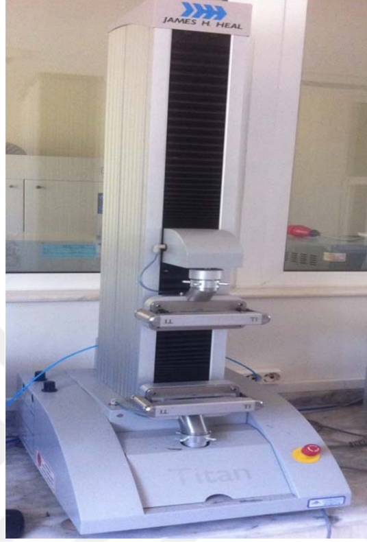
Şekil 5.1. Titan universal mukavemet test cihazı
