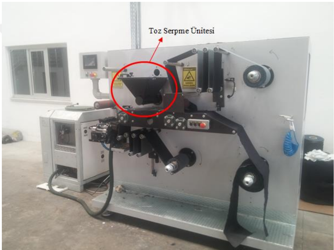
Şekil 3.3. Kaplama/Laminasyon cihazı ve toz serpmeye ünitesi
