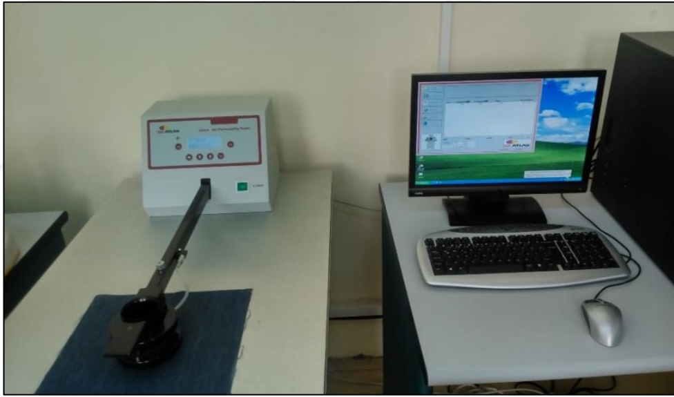
Şekil 3.7. SDL Atlas Dijital hava geçirgenliği test cihazı
