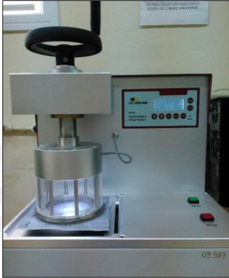
Şekil 3.8. SDL Atlas su geçirmezlik test cihazı
