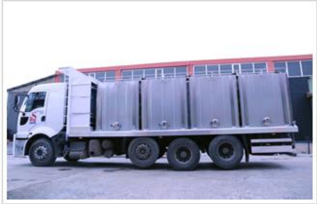
Şekil 3.5 Araç üstü canlı balık nakil tankları (Kişisel arşiv, 2019)
