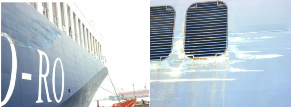
Şekil 3.4. UND Ege Ro-Ro sancak tarafından kıç bölümüne kadar hasar
