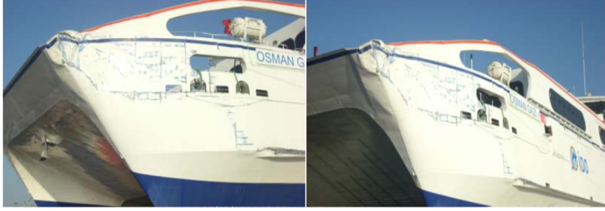
Şekil 3.5. Osman Gazi-1 feribot iskele baş omuzluğunda hasar
