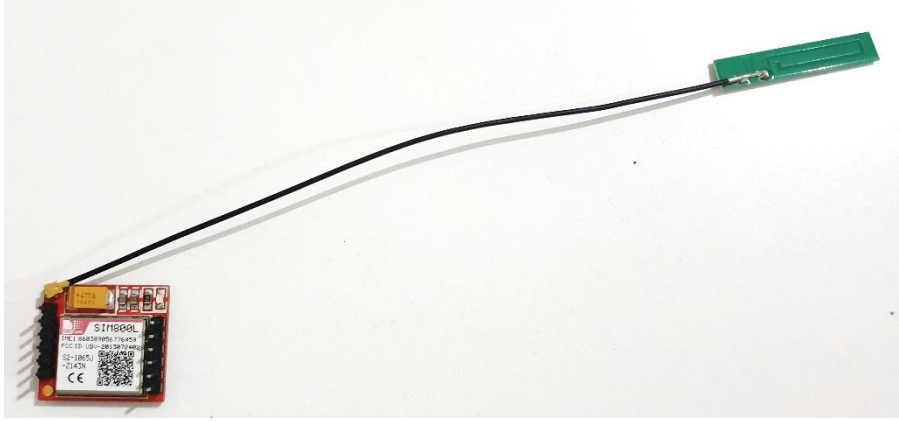
Şekil 3.7. GPRS modülü SIM800L Modeli
