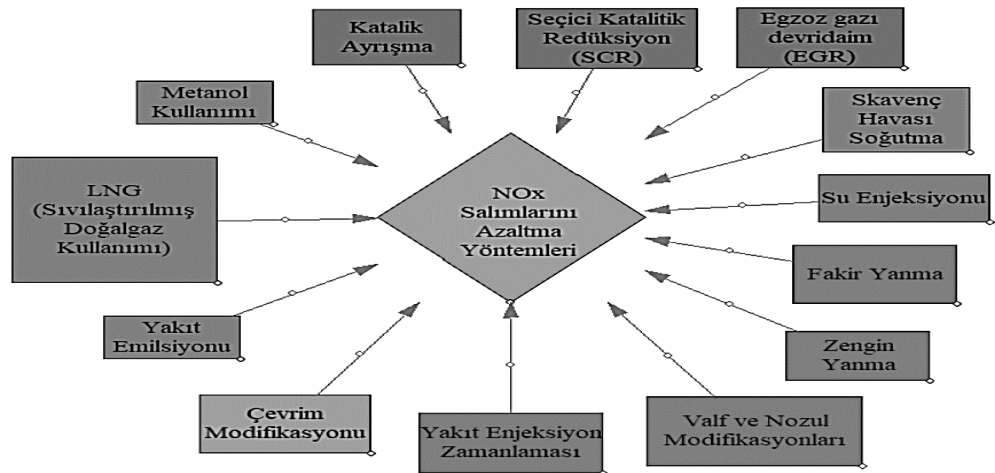
Şekil 1.9 NO x salımlarını azaltma yöntemleri (Woodyard, 2009)
