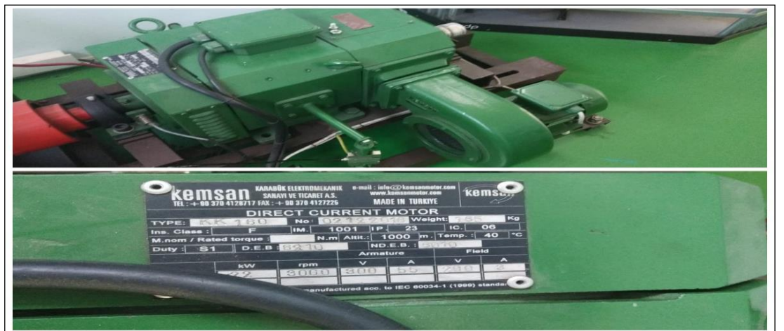
Şekil 3.28 KK 160 tipi doğru akım motorlu dinamometre (Kişisel arşiv, 2021)
