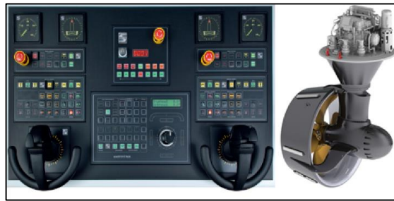
Şekil 3.8 SRP dümen-pervane sistemi (Schottel, 2013)
