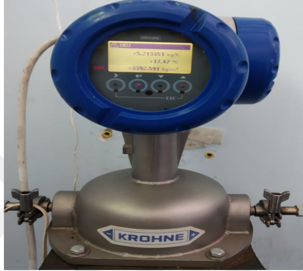
Şekil 3.29 Optimass 3400 C S01 model debimetre (Kişisel arşiv, 2021)
