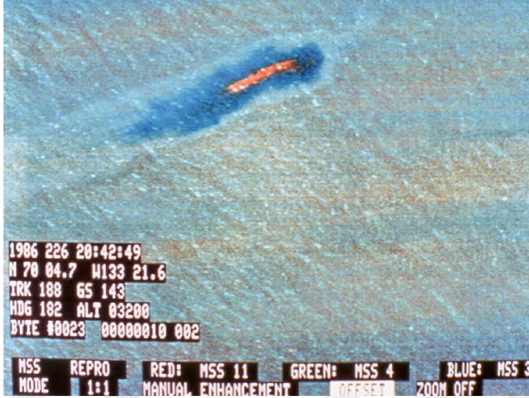
Şekil 31. Petrolle kaplı deniz yüzeyinin UV görüntüsü (Fingas, 2012)
