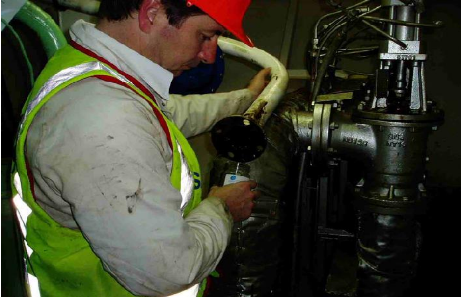
Şekil 42. Makine dairesinden numune alınması (Interpol Illegal Oil Discharges from Vessels, 2007).
