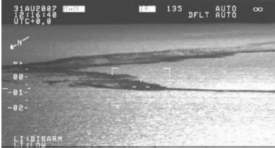
Şekil 32. Petrolle kaplı bir deniz yüzeyinin FLIR görüntüsü (Strategic View on Oil Spill Response Support Using In-Situ and Remote Sensing Data Tools, 2019)
