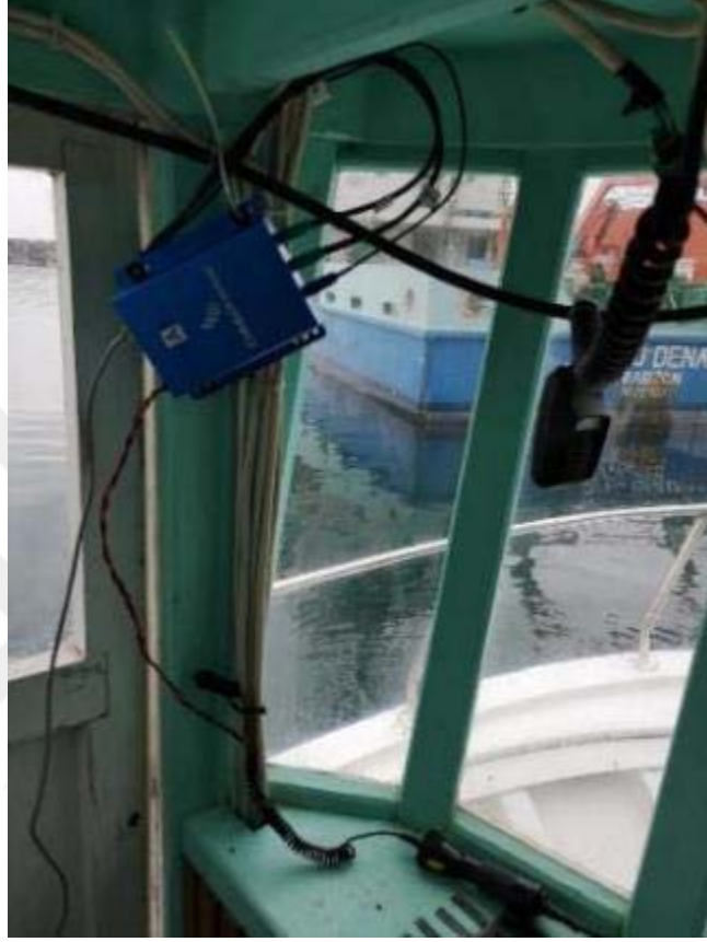
Şekil 19. Tekne içi ölçüm cihazı düzeneği (alıcı)
