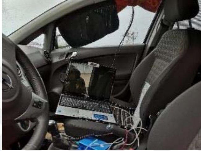
Şekil 16. Otomobil içi ölçüm cihazı düzenegi (verici)
